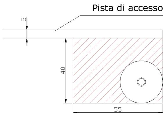
**Figura 6-8 – Tipico piazzola di esercizio con quote espresse in metri**
