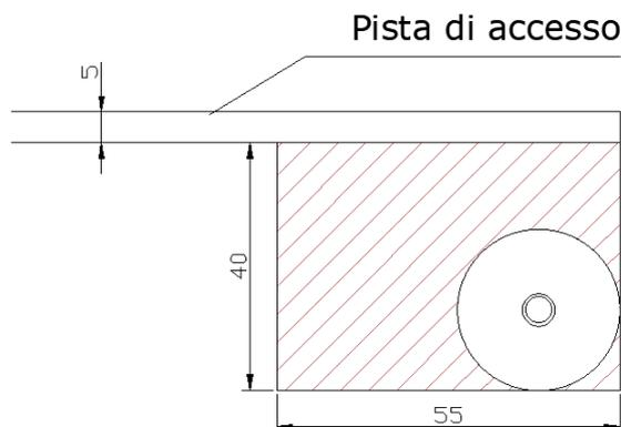
**Figura 5-11 – Tipico piazzola di esercizio con quote espresse in metri**
