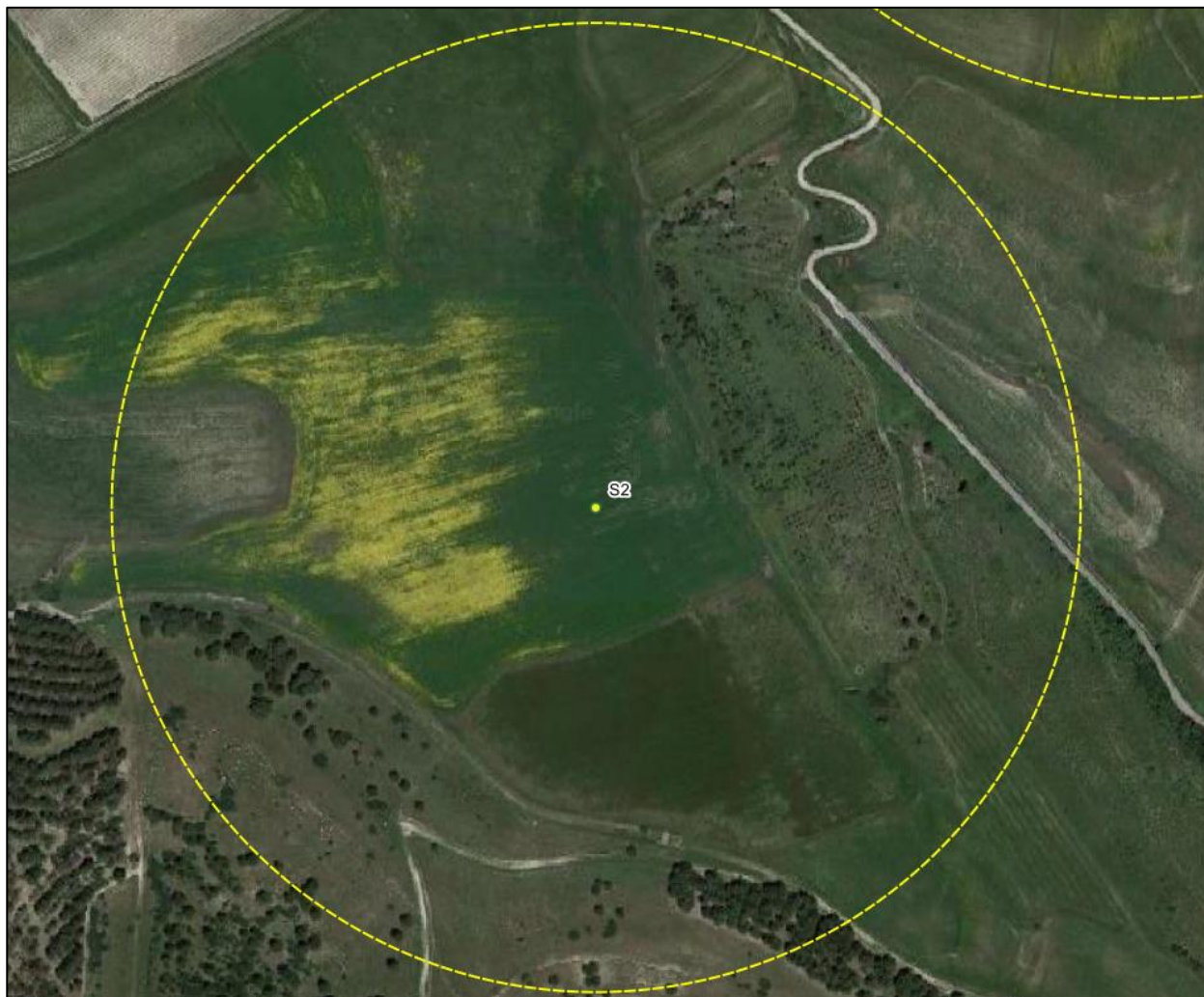
Figura 7-1 – Gittata dell'intera pala (254,5 m) in colore giallo, da aerogeneratore S2
