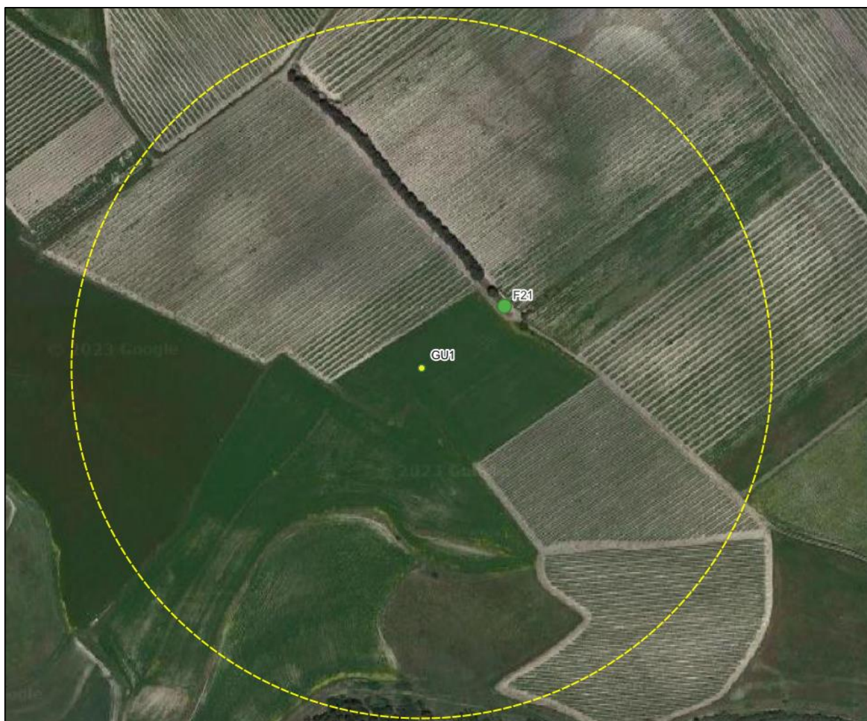
Figura 7-4 – Gittata dell'intera pala (254,5 m) in colore giallo, da aerogeneratore GU1
