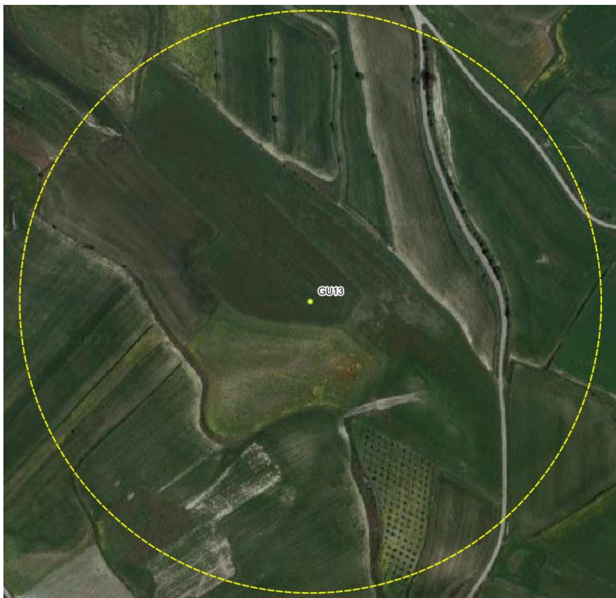
Figura 7-8 – Gittata dell'intera pala (254,5 m) in colore giallo, da aerogeneratore GU13
