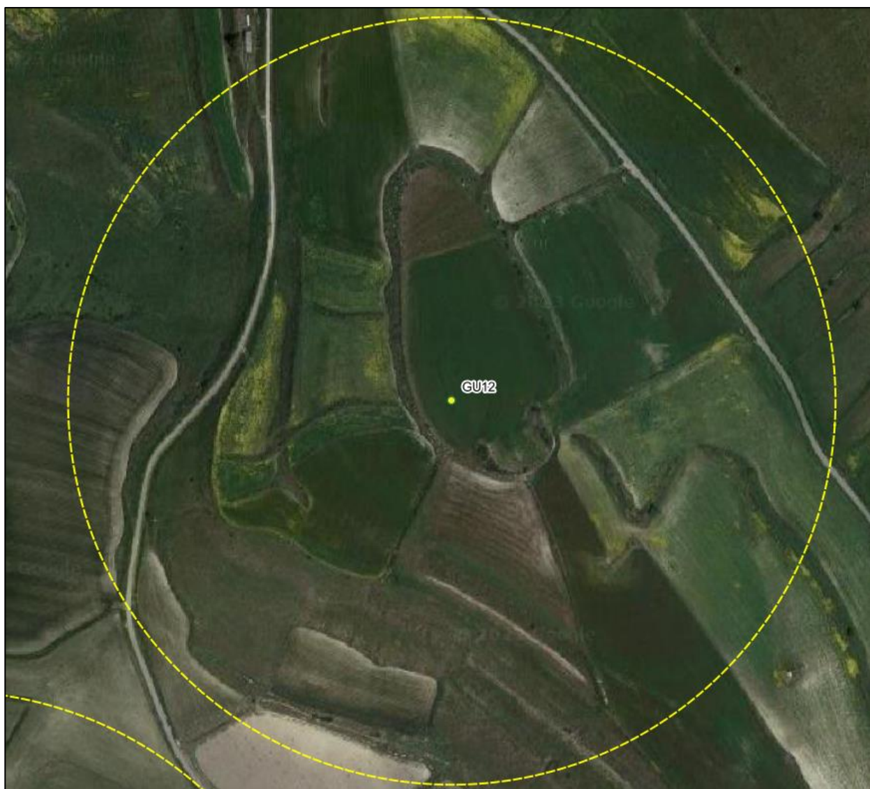
Figura 7-7 – Gittata dell'intera pala (254,5 m) in colore giallo, da aerogeneratore GU12
