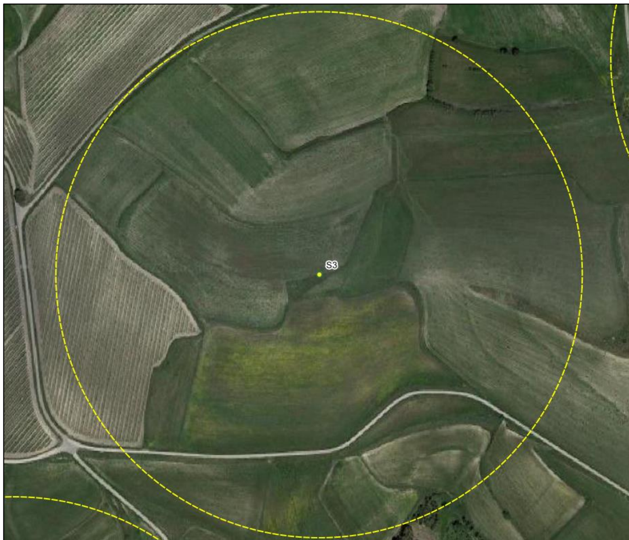
Figura 7-2 – Gittata dell'intera pala (254,5 m) in colore giallo, da aerogeneratore S3
