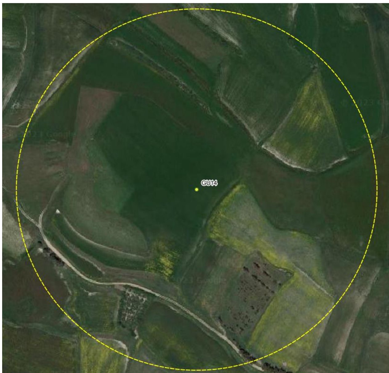
Figura 7-9 – Gittata dell'intera pala (254,5 m) in colore giallo, da aerogeneratore GU14
