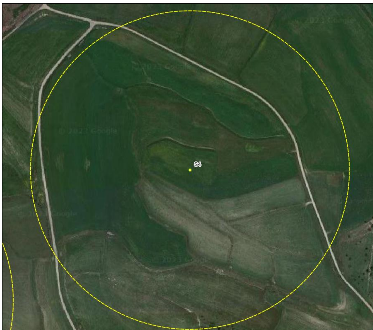
Figura 7-3 – Gittata dell'intera pala (254,5 m) in colore giallo, da aerogeneratore S4
