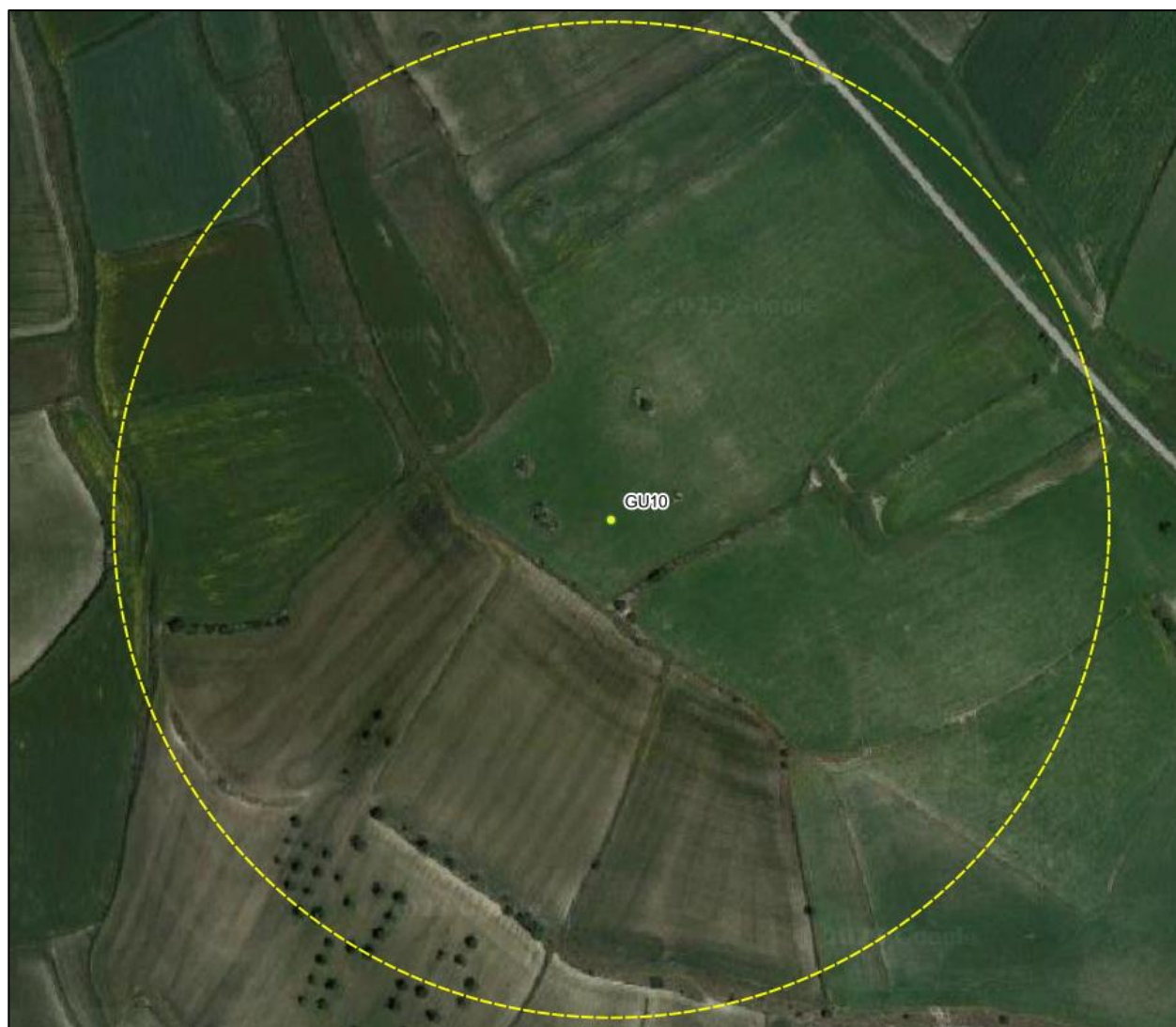
Figura 7-5 – Gittata dell'intera pala (254,5 m) in colore giallo, da aerogeneratore GU10
