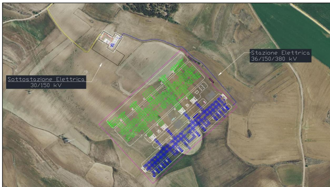
**Figura 5-6 – Allacciamento con elettrodotto interrato in AT alla stazione elettrica di Sanluri**
