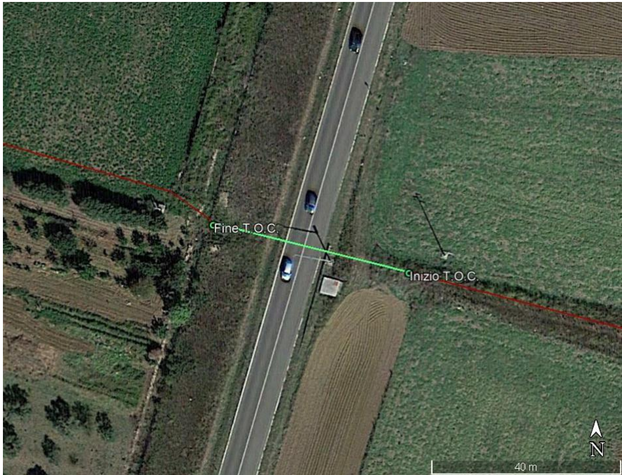
Figura 6-2 – Risoluzione interferenza I9 su ortofoto (elettrodotto interrato in MT in colore rosso)
