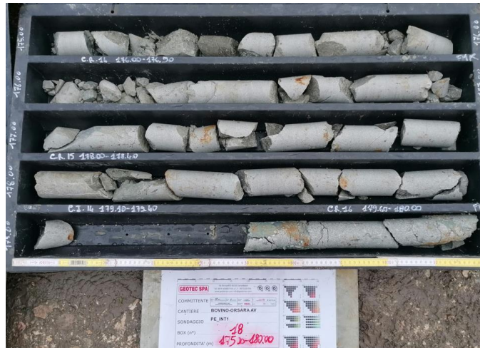
Figura 4-6 – Carote prelevate nella litofacies FAEC, sondaggio PE-int-01.
