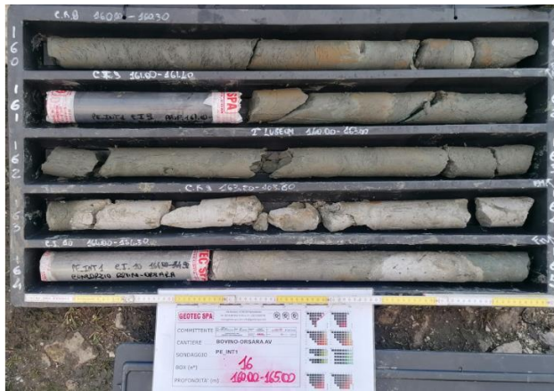
Figura 4-2 – Carote prelevate nella litofacies FAEam, sondaggio PE-int-01.
