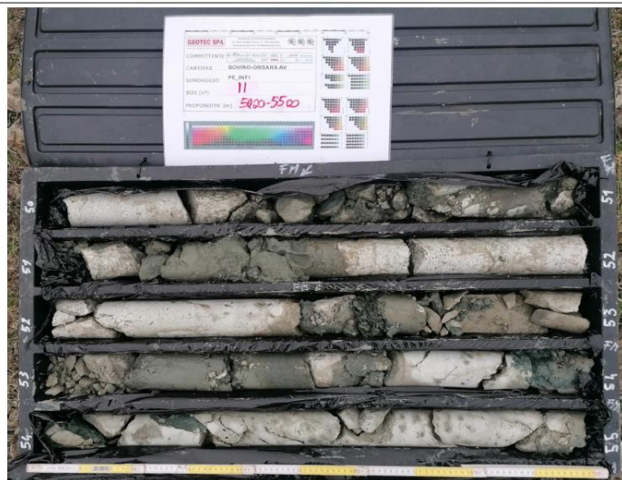
Figura 4-4 – Carote prelevate nella litofacies FAEm, sondaggio PE-int-01.
