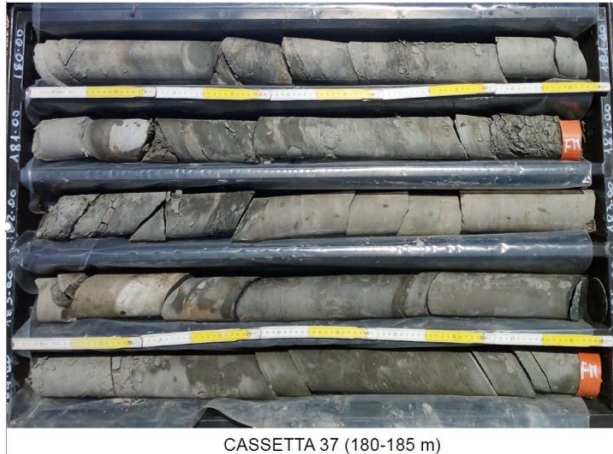
Figura 4-1 – Carote prelevate nella litofacies FAEam, sondaggio BO S11.
