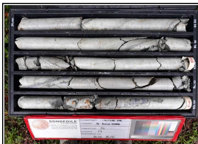
Figura 4-5 – Carote prelevate nella litofacies FAEc, sondaggio BO PD S1.
