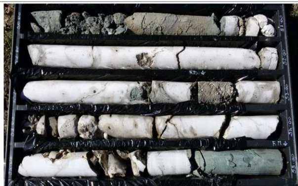
Figura 4-3 – Carote prelevate nella litofacies FAEMA, sondaggio BO PD S3.
