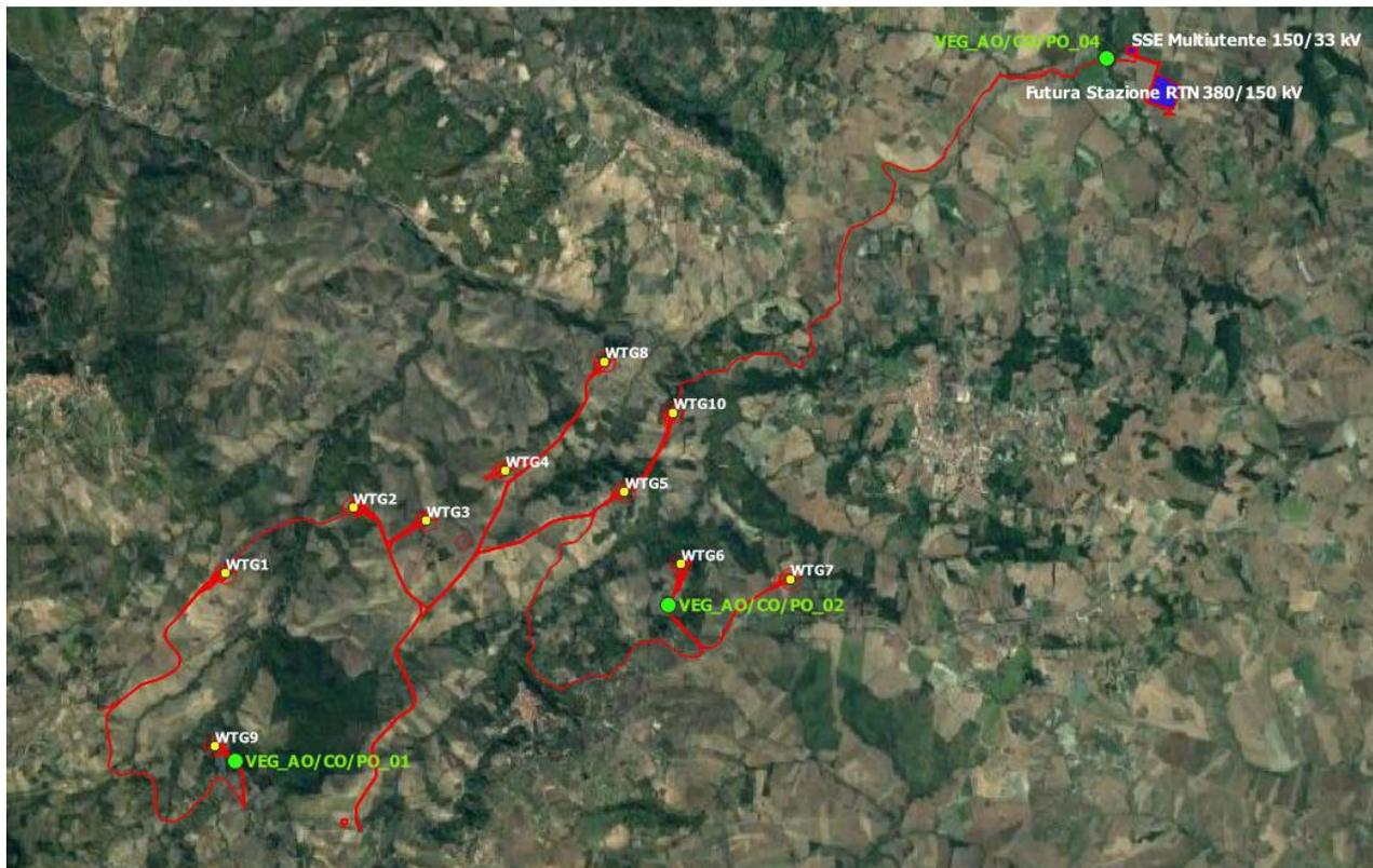
Figura 3: Inquadramento su base ortofoto dei punti di monitoraggio della vegetazione (in verde) rispetto al layout di impianto (in rosso)
