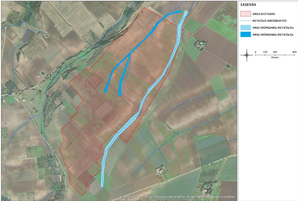
Figura 6.1 – Sovrapposizione aree inondabili per Tr 200 anni con l'areale di progetto (cfr. Allegato 3)
