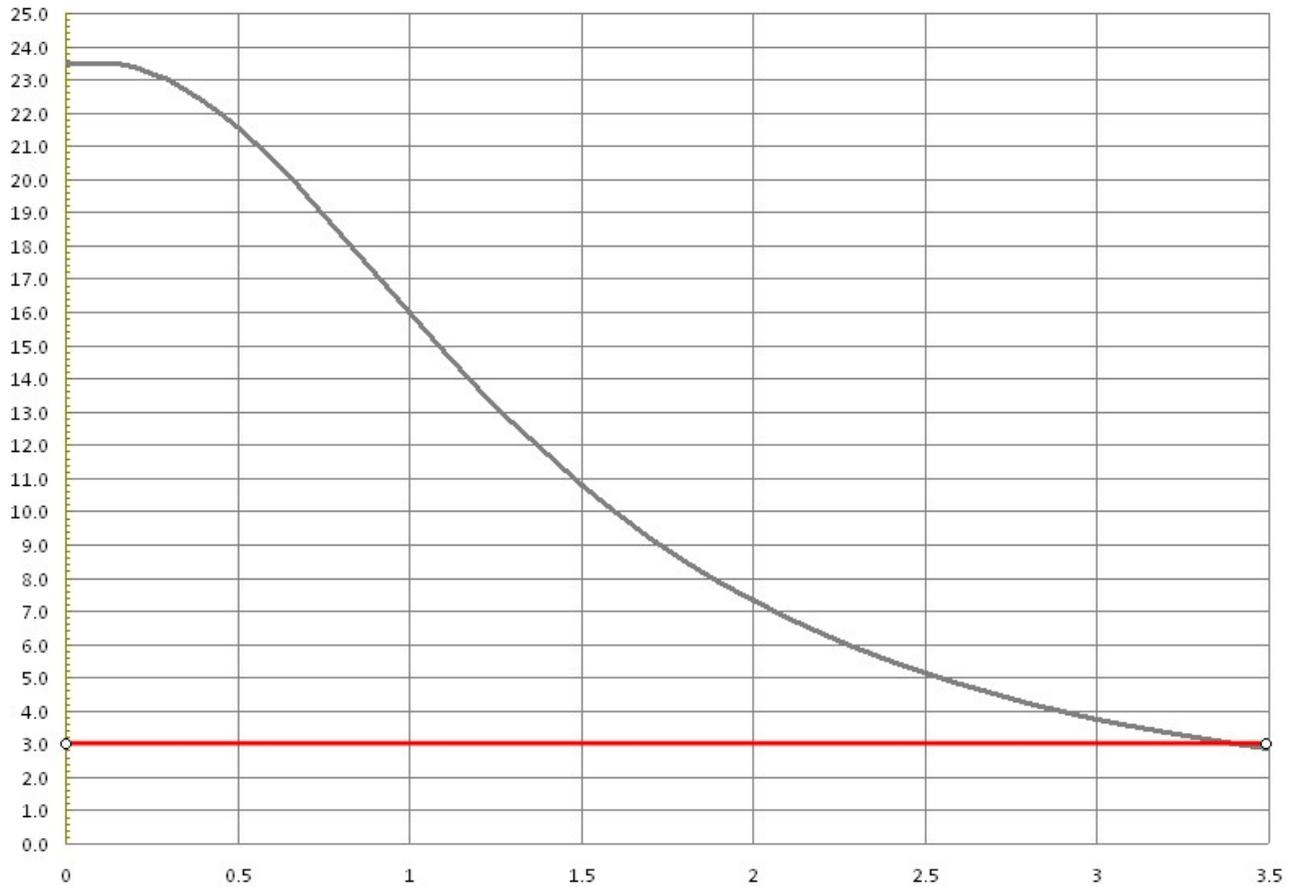
Valore dell'induzione magnetica al suolo del cavidotto MT nel tratto a 3 terne con disposizione in piano.
