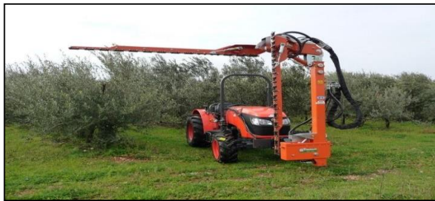
Figura 7.14: Esempio di potatrice meccanica frontale a doppia barra (taglio verticale + topping) Figura 7.14: Esempio di potatrice meccanica frontale a doppia barra (taglio verticale + topping) utilizzabile su tutti le colture arboree intensive e superintensive (Foto: Rinieri S.r.l.)
