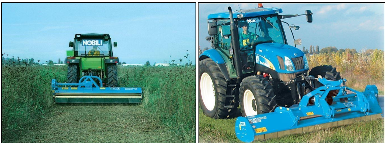
Fig. 7.3: Esempi di trincia posteriore e anteriore di notevole larghezza (Foto: Nobili S.r.l.)
