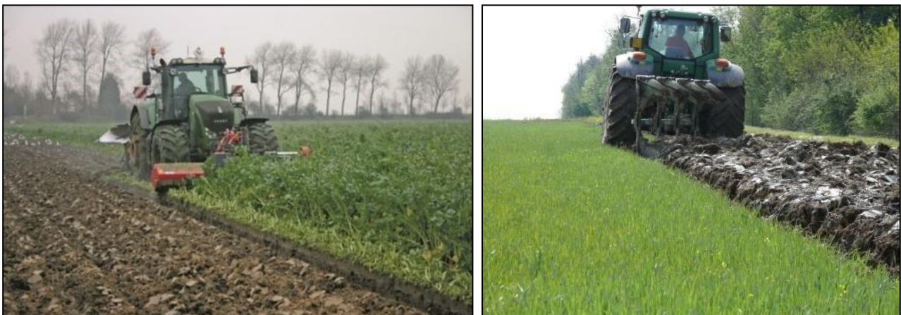
Fig. 7.1: Esempio di pratica del sovescio in pieno campo. Si noti, nell'immagine a sinistra, l'impiego di una trincia frontale montata sulla stessa trattore per alleggerire il carico sull'aratro
