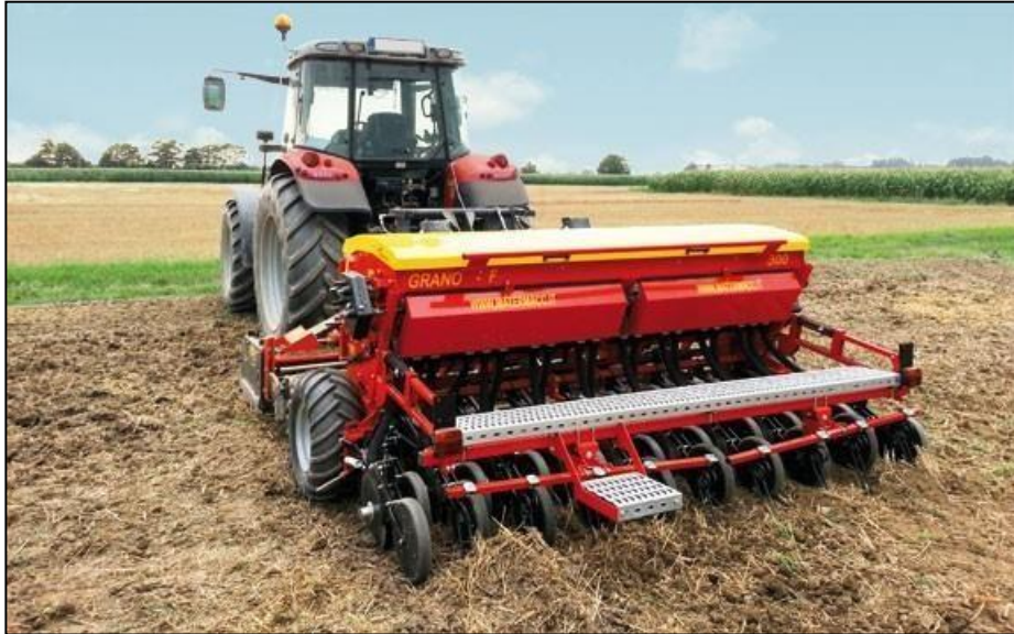
Fig. 7.2: Esempio di seminatrice di precisione per tutte le tipologie di sementi (Foto: MaterMacc S.p.a.)
