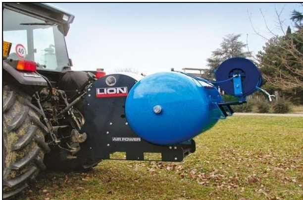
Figura 7.13: Compressore PTO per il funzionamento di strumenti pneumatici per l'arboricoltura (Foto: Campagnola
