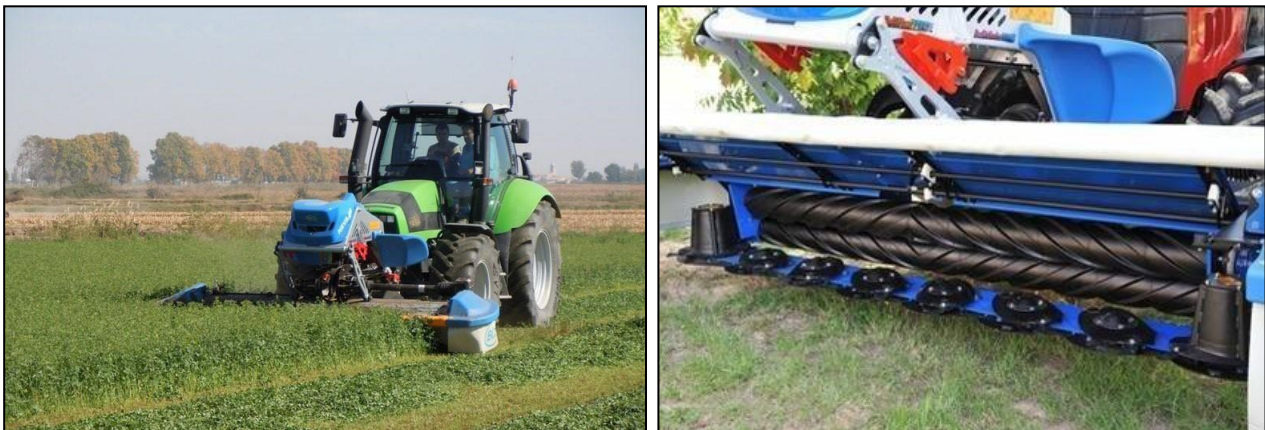
Fig. 7.4: Esempio di falciacondizionatrice frontale e particolare dei rulli in gomma (Foto: BCS)
