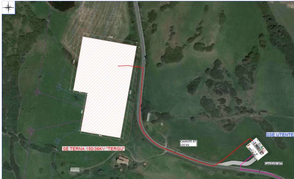
Fig. 27 planimetria stazione elettrica Terna "Tergu" e linee AT
