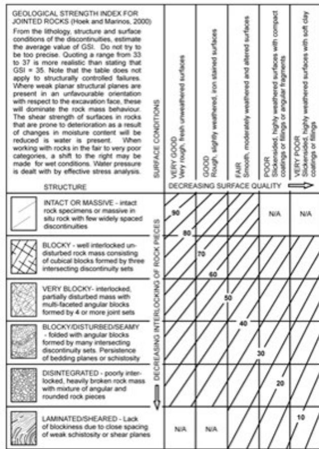
Figura 17 – Grafico per la determinazione dell'Indice GSI (Hoek et al. 2000)
