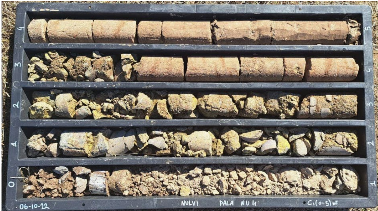
Figura 11 – Sondaggio S 1: 0,00 – 5,00 m.
