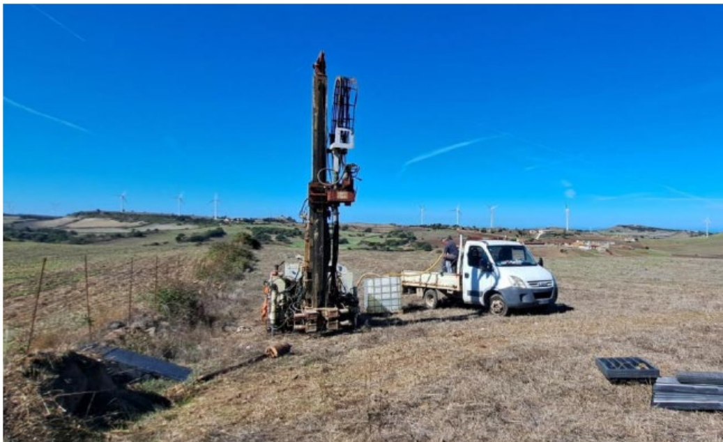
Figura 10 – Posizionamento del sondaggio eseguito in prossimità del sito di posa dell'aerogeneratore NU3.
