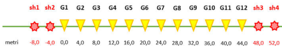
Schema 1. Schema geometrico di acquisizione dei dati per lo stendimento M1 di lunghezza L=44.00 m
