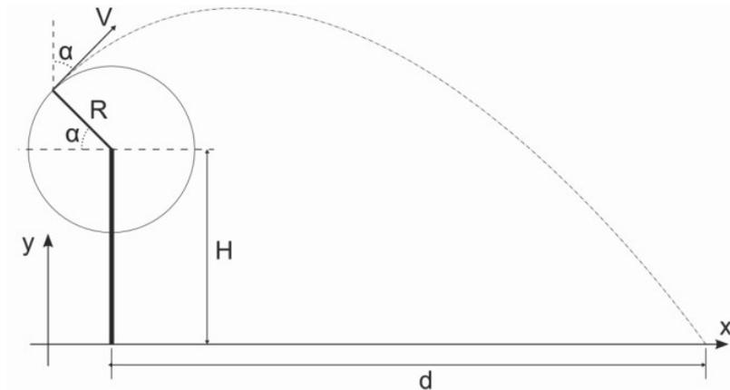
*Figura 3 – Schema della traiettoria della pala in caduta.*
