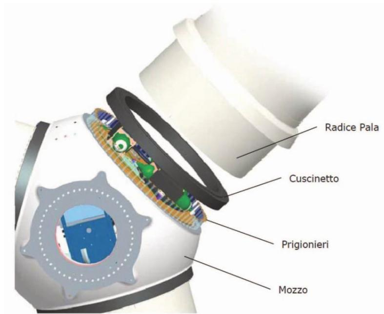
*Figura 2 - Schema strutturale di collegamento elemento pala – mozzo.*
