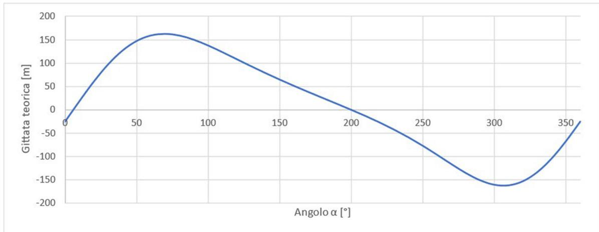
**Figura 4 – Calcolo della gittata in funzione dell'angolo  $\alpha$  sotteso dalla pala (posizione della pala al momento della rottura).**
