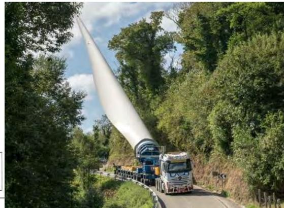
Figura 37 - Caratteristiche dimensionali dei mezzi di trasporto con trasbordo dei pezzi dell'aerogeneratore per la viabilità interna con blade lifter
