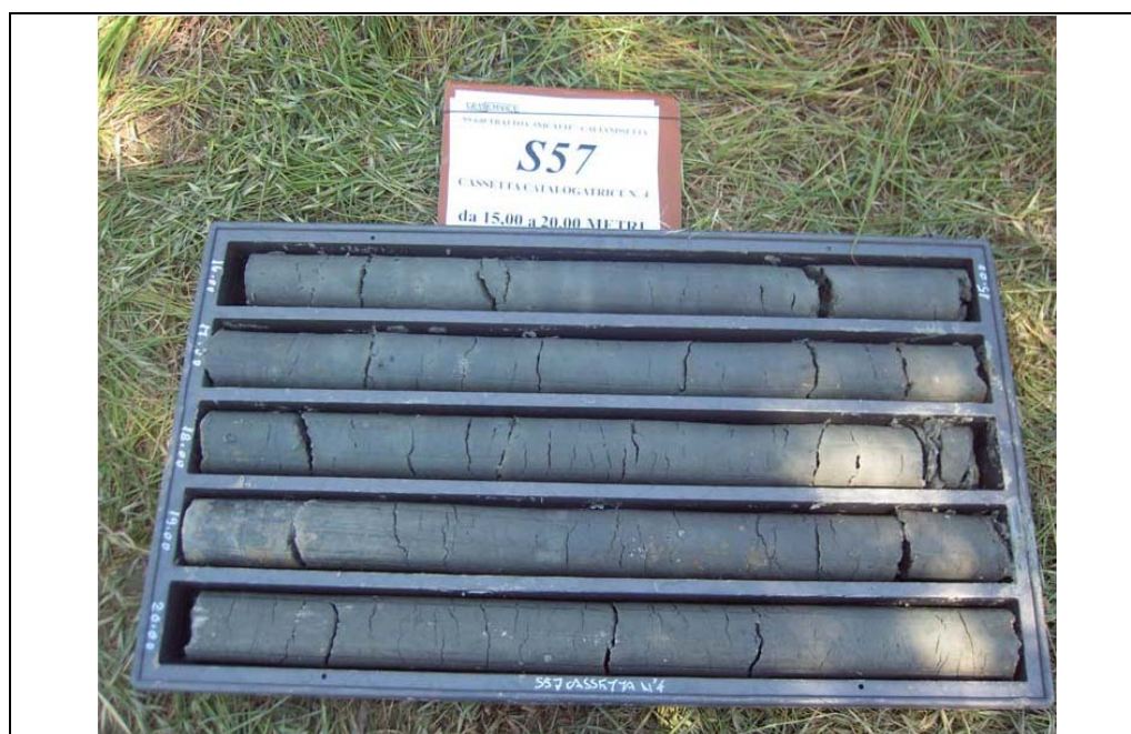
Sondaggio S57 – Cassetta n.4 (15-20 m). Complesso argilloso: argilla limo-sabbiosa di colore grigio azzurro consistente a tratti scagliosa.
