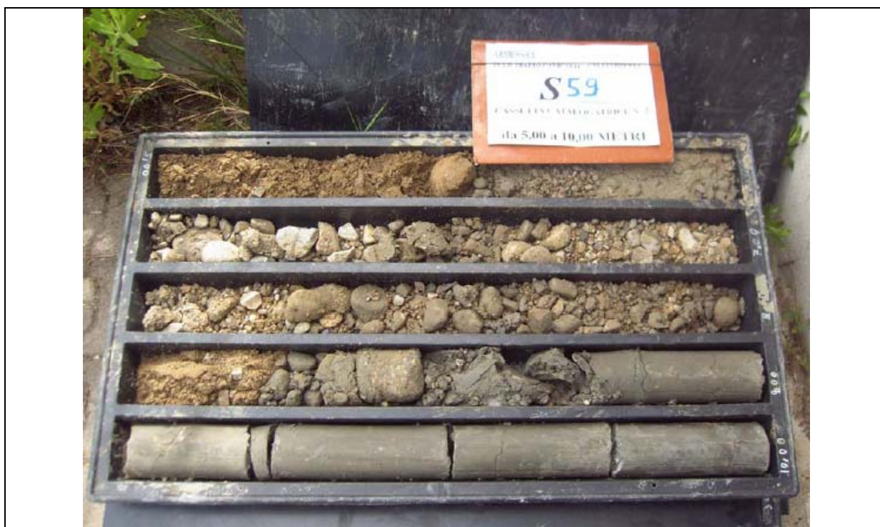
Sondaggio S59 – Cassetta n.2 (5-10 m). Tipici depositi alluvionali costituiti da ghiaia e sabbia in scarsa matrice limo sabbiosa.
