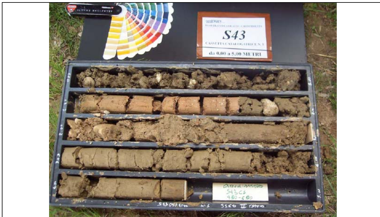
Sondaggio S43 – Cassetta n.1 (0 – 5 m). Alluvioni recenti costituite da sabbia limosa debolmente ghiaiosa con qualche blocco calcareo.
