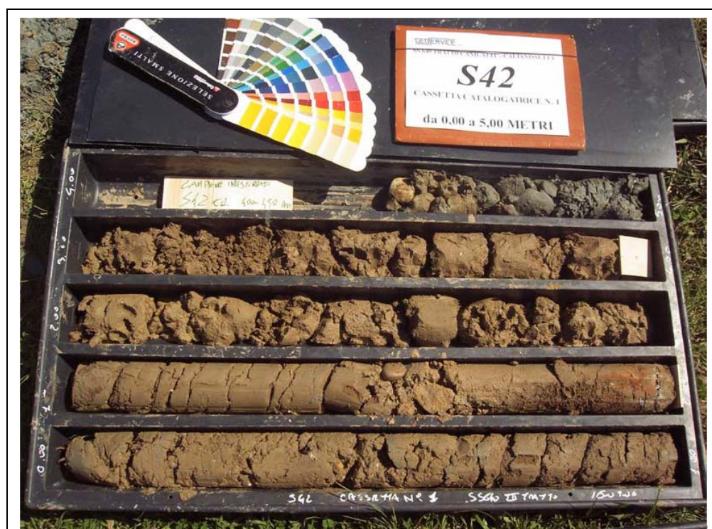
Sondaggio S42 – Cassetta n.1 (0-5 m). Depositi alluvionali costituiti sabbia limosa con ghiaia e ciottoli di diversa natura.
