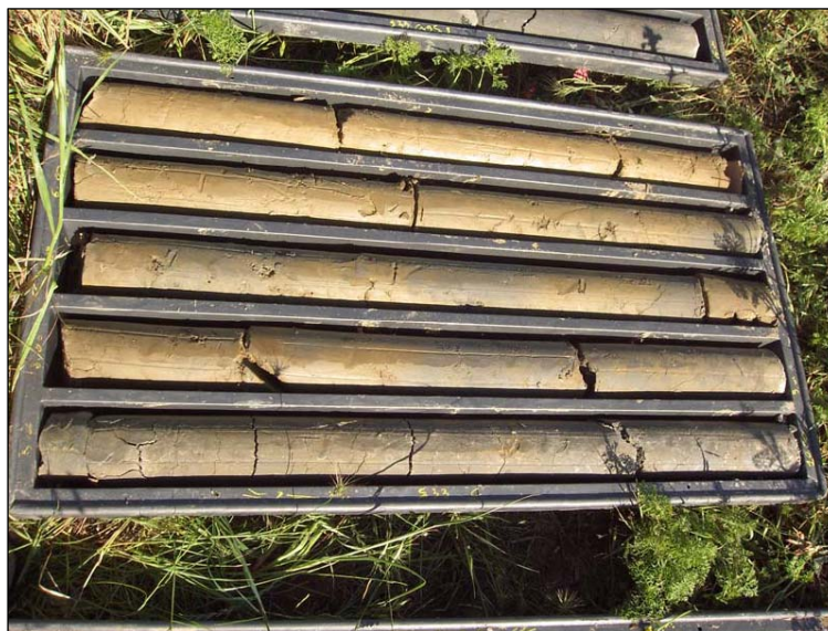
Sondaggio S33 – Cassetta n.2 (5-10 m). Passaggio dai limi argillosi alterati alle argille brecciate scagliose.
