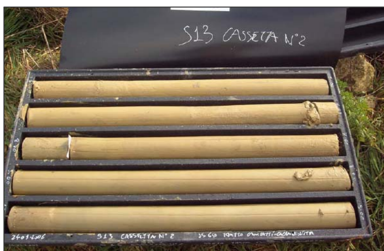
Sondaggio S13 – Cassetta n.2 (5-10 m). Limo argilloso con sabbia, afferente al complesso argilloso pliocenico.
