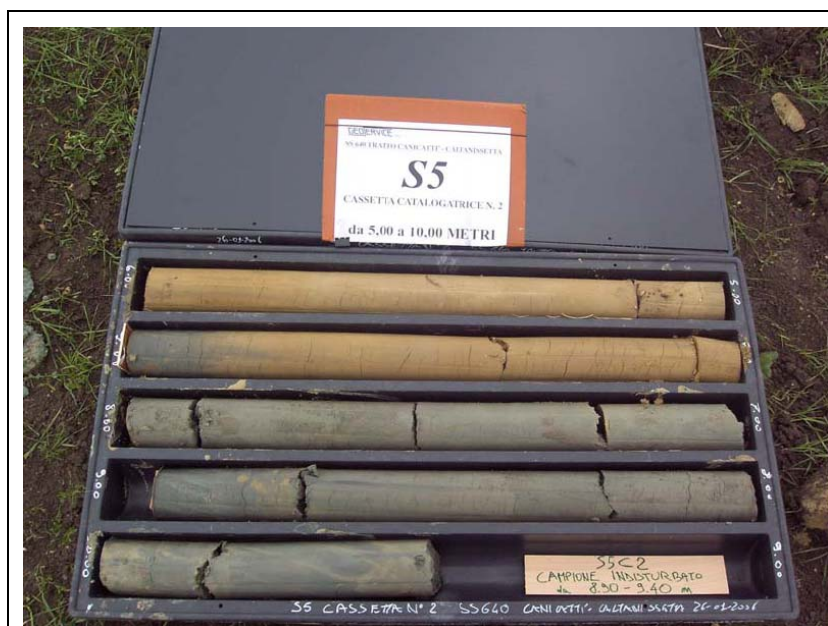
Sondaggio S05 – Cassetta n.2 (5-10 m). Complesso argilloso sommitale passante al livello profondo di argille grigio azzurre compatte e poco plastiche.
