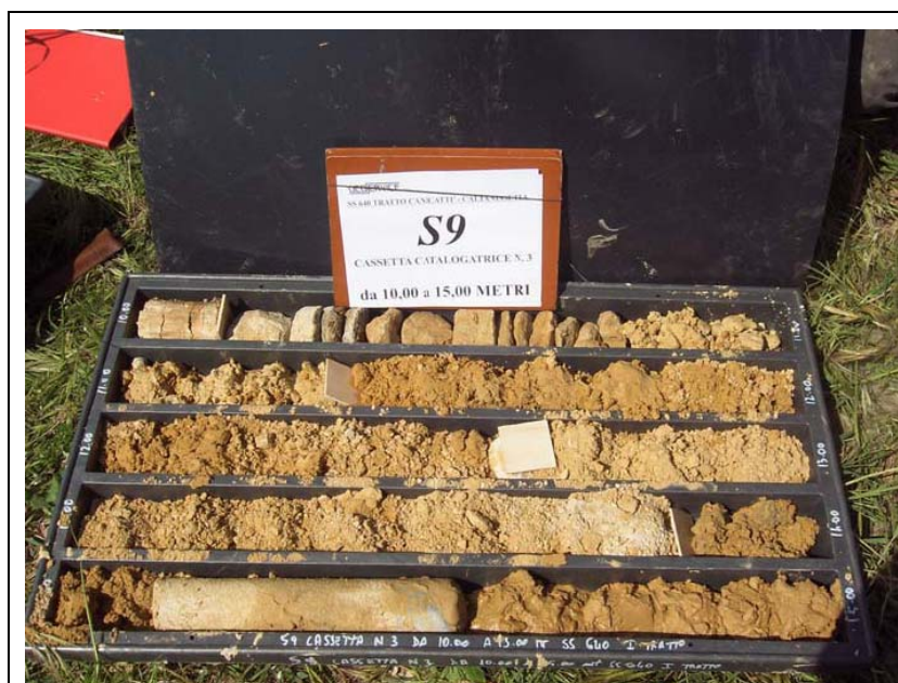
Sondaggio S9 – Cassetta n.3 (10-15 m). Sabbie giallastre con intercalazioni quarzarenitiche
