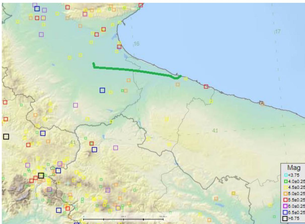
Figura 4-15: Magnitudo dei Terremoti nell'intorno dell'area di progetto estratti dal database CPTI15 (INGV) (Tracciato cavidotto in verde)
