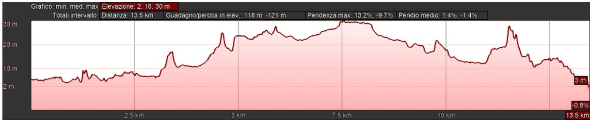
**Figura 4-5: Profilo di elevazione del tracciato del cavidotto dall' approdo a terra al fiume Ofanto**
