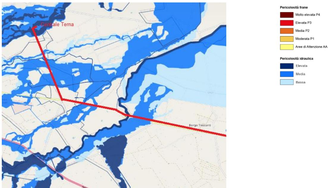
Figura 4-8: Pericolosità idraulica del percorso a terra del cavidotto estratta da cartografia pericolosità e rischio del progetto Iffi in corrispondenza del Torrente Carapelle e della Centrale Terna
