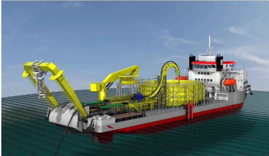
Figura 4.3: Esempio di nave posa cavo
