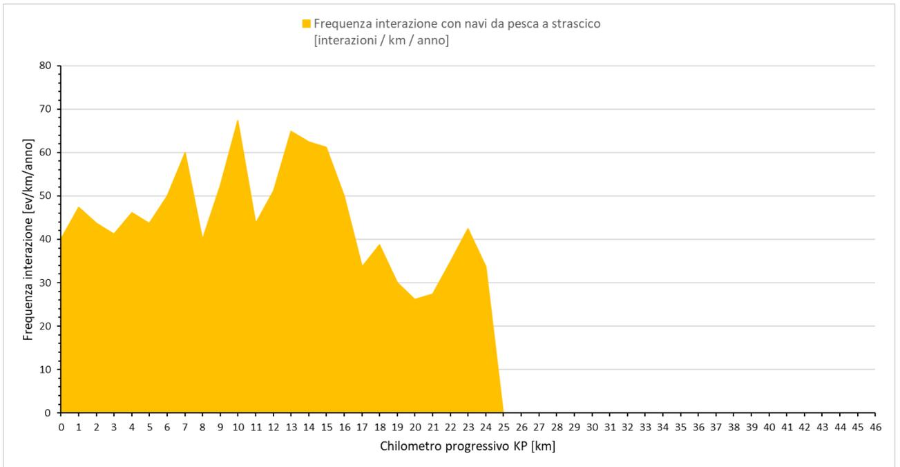
**Figura 5-13: Frequenza interazione con cavidotti per imbarcazioni adibite alla pesca a strascico, caratterizzato per KP di cavidotto**
