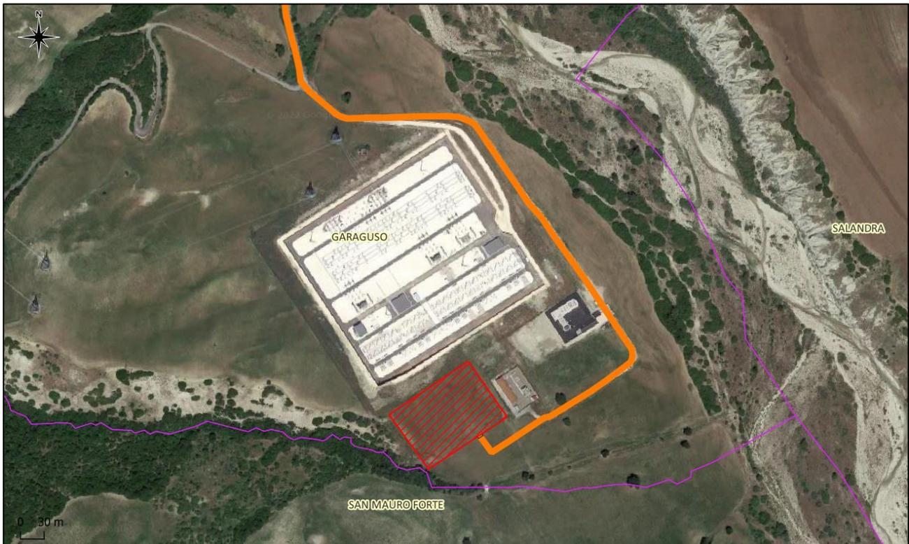
**Opere di connessione Cavidotto interrato MT 36 kV**
