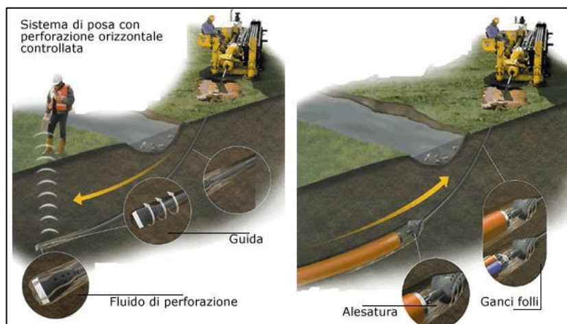
Figura 8: Posa in opera tubazione per alloggiamento cavi
