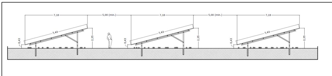
Vista laterale della struttura con inclinazione di 15°
