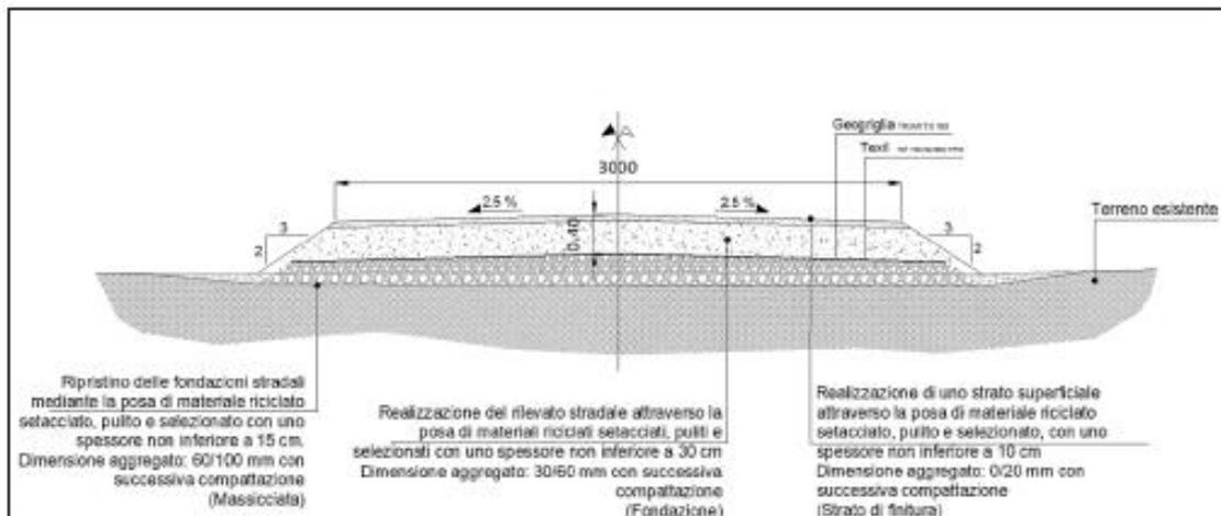
Fig.: Tipico della sezione stradale
