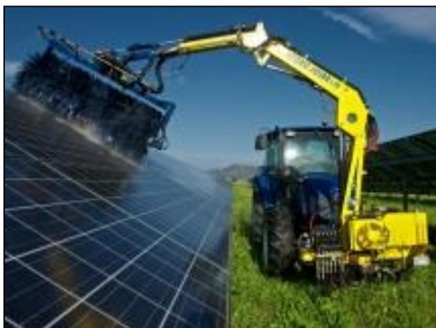
La **pulizia dei moduli** avviene mediante il passaggio di macchine automatiche dotate di spazzole. Tali macchine sono tipicamente dotate di sistemi per la demineralizzazione dell'acqua, in modo da non lasciare aloni o residui di calcare sui moduli. Un esempio di macchina per la pulizia dei moduli FV è mostrato nelle immagini seguenti.
