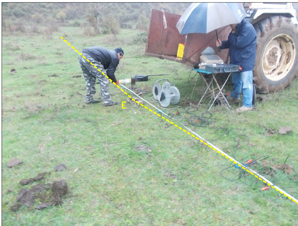
Foto 11: Postazione ed allineamento della Base Sismica B.S.5 - particolare dell'esecuzione di una battuta in onde P nel punto di scoppio E -
