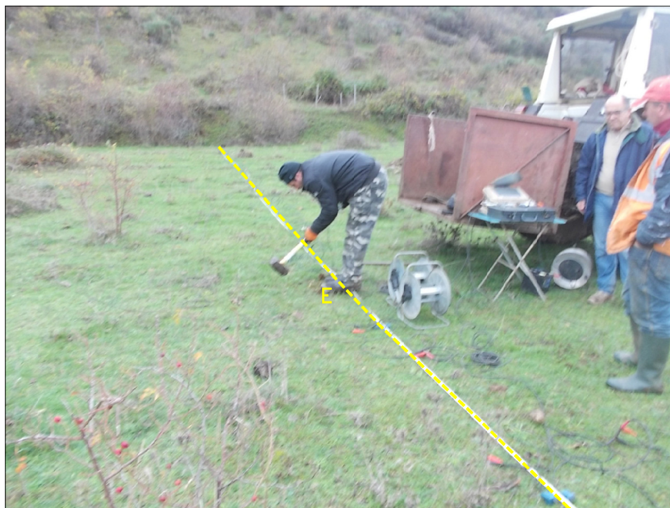
Foto 8: Postazione ed allineamento della Base Sismica B.S.4 - particolare dell'esecuzione di una battuta in onde S nel punto di scoppio E -
