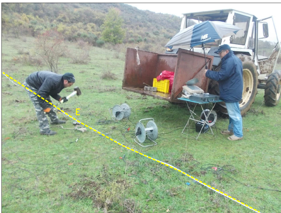
Foto 3: Postazione ed allineamento della Base Sismica B.S.3 - particolare dell'esecuzione di una battuta in onde P nel punto di scoppio E -
