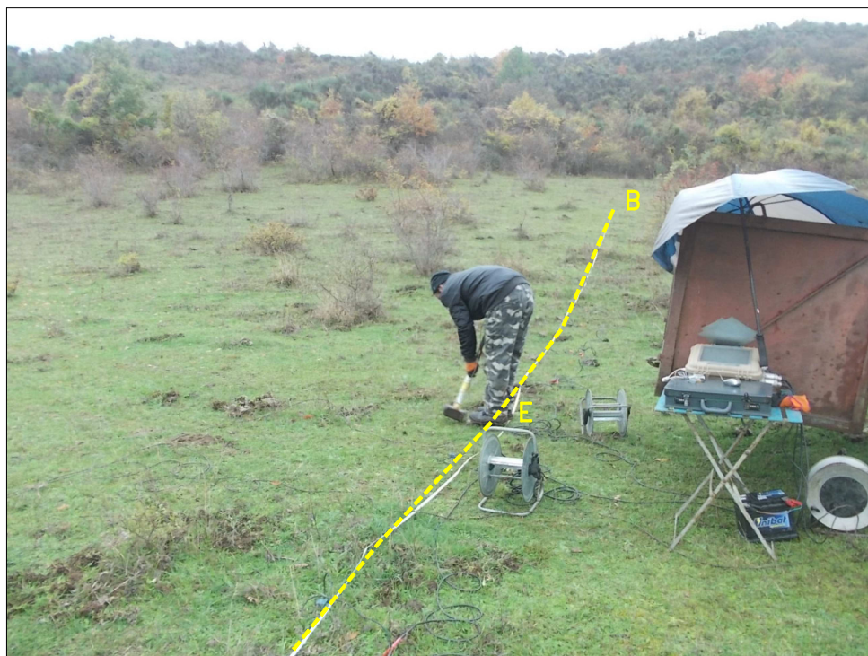
Foto 4: Postazione ed allineamento della Base Sismica B.S.3 - particolare dell'esecuzione di una battuta in onde S nel punto di scoppio E -
