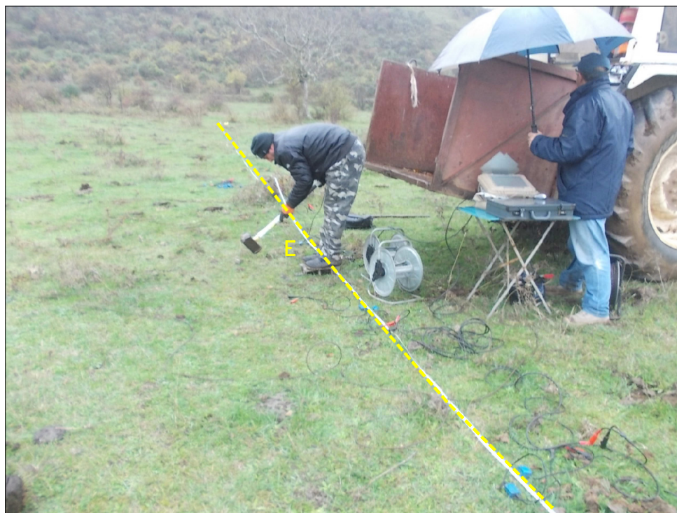
Foto 12: Postazione ed allineamento della Base Sismica B.S.5 - particolare dell'esecuzione di una battuta in onde S nel punto di scoppio E -
