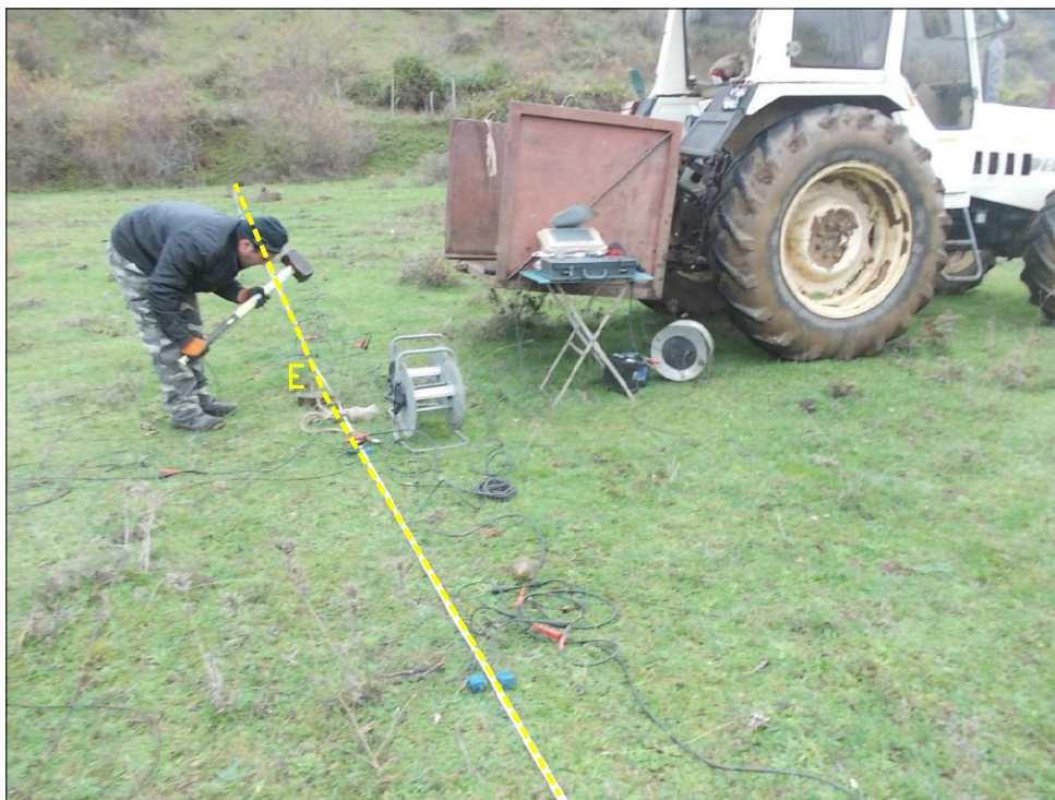
Foto 7: Postazione ed allineamento della Base Sismica B.S.4 - particolare dell'esecuzione di una battuta in onde P nel punto di scoppio E -
