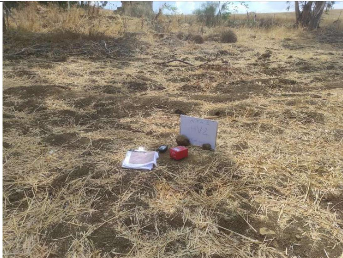
Particolare esecuzione indagine sismica HVS2 Area 1. Coordinate: 37.772863°N, 13.690705°E
