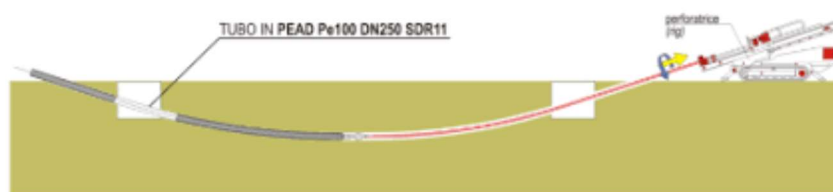
Figura n° 18 : Sezione Cavidotto di connessione 380/150/36 KV con la stazione RTN con operazione TOC
