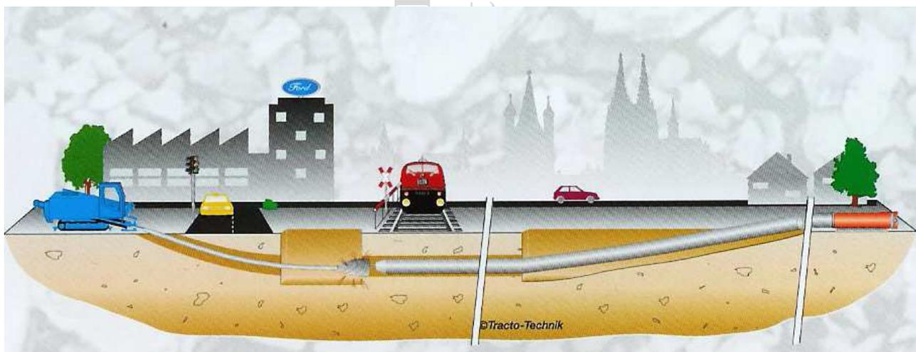
**Fig. 4. Schema di principio dell'attraversamento in T.O.C.**
