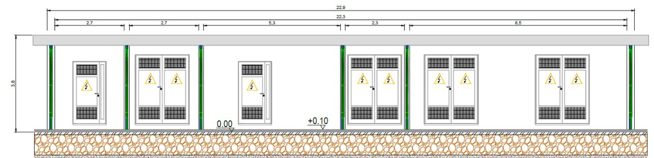
**Fig. 10. Prospetto principale dei locali tecnici della SSE.**
