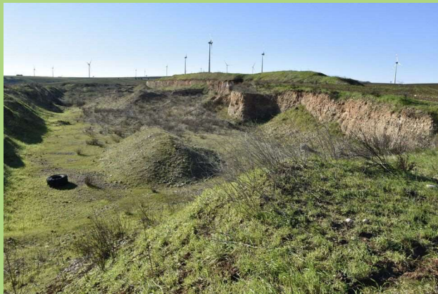
Foto 21. Interno della cava "Dell'Erba". Sono visibili i cumuli di materiale di scarto della coltivazione della cava ed il fronte della cava stessa - 3.
