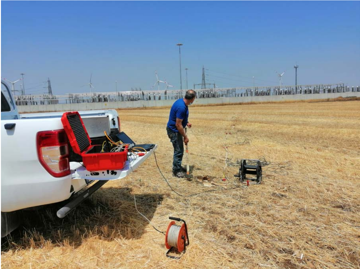
Profili sismici a rifrazione e con metodologia MASW eseguiti in lotto adiacente alla Stazione di Castellaneta 150/380 kV ed al cavidotto
