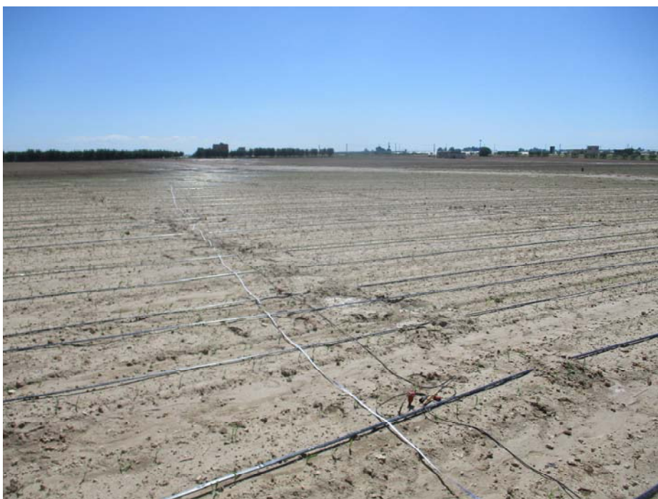
Esecuzione indagine sismica a rifrazione n. 5 e Masw n. 3 sullo stesso stendimento
