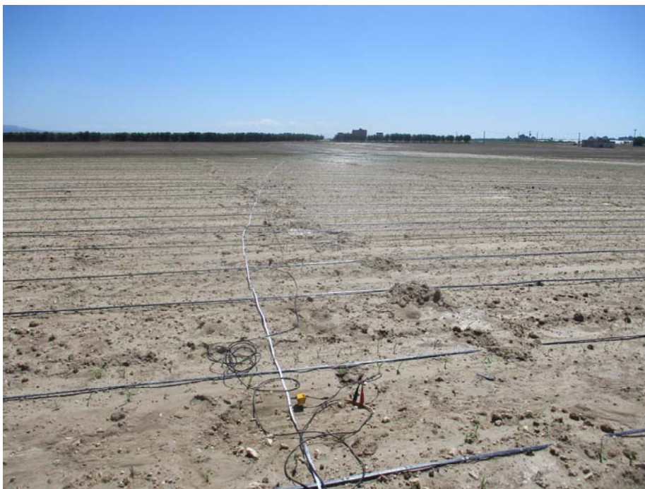
Esecuzione indagine sismica a rifrazione n. 5 e Masw n. 3 sullo stesso stendimento
