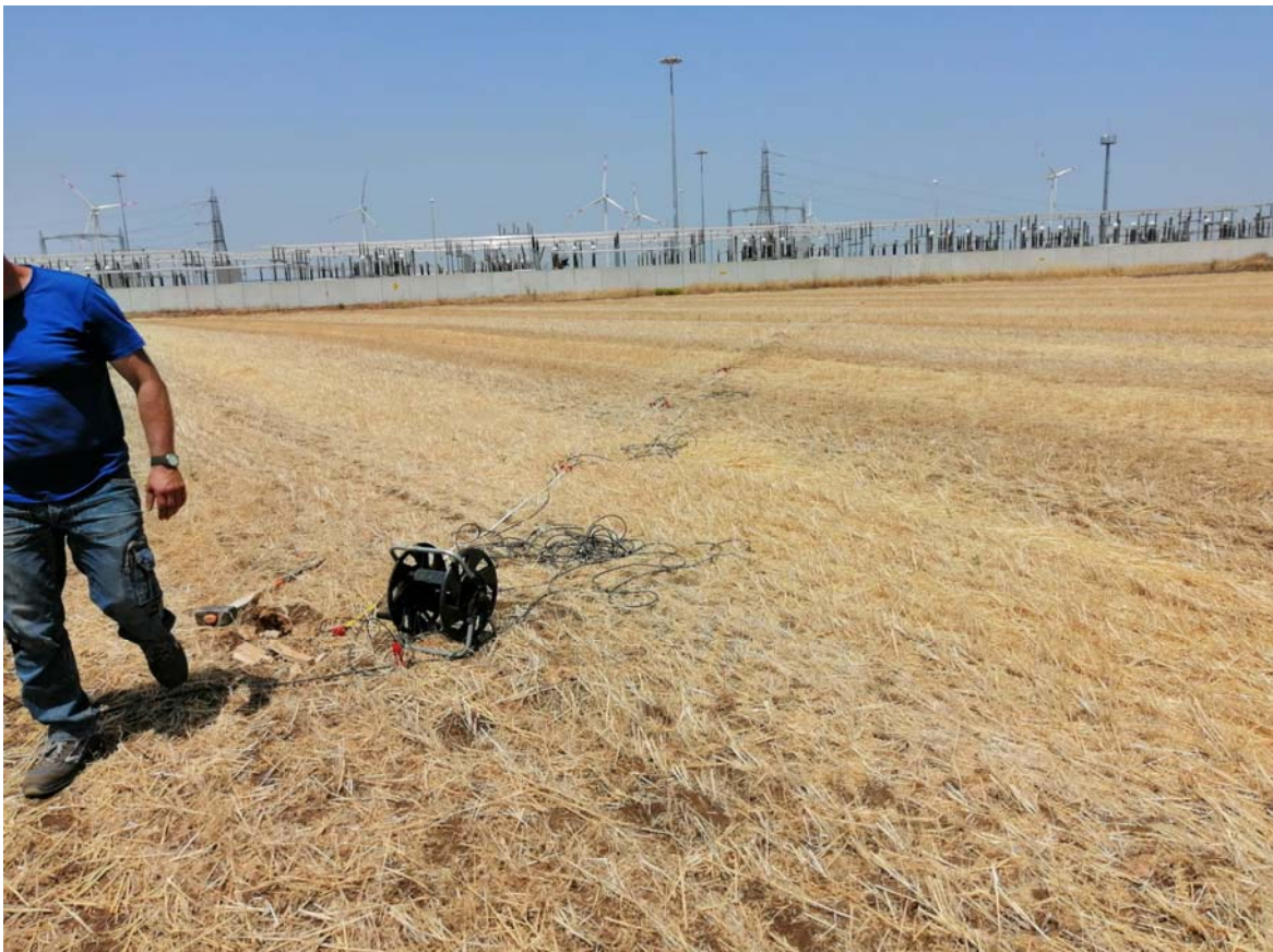
Profili sismici a rifrazione e con metodologia MASW eseguiti in lotto adiacente alla Stazione di Castellaneta 150/380 kV ed al cavidotto
