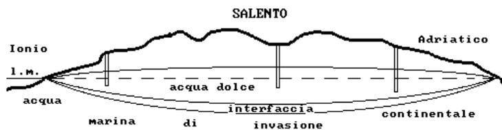
Fig. 7 - Sezione idrologica della Penisola Salentina.
