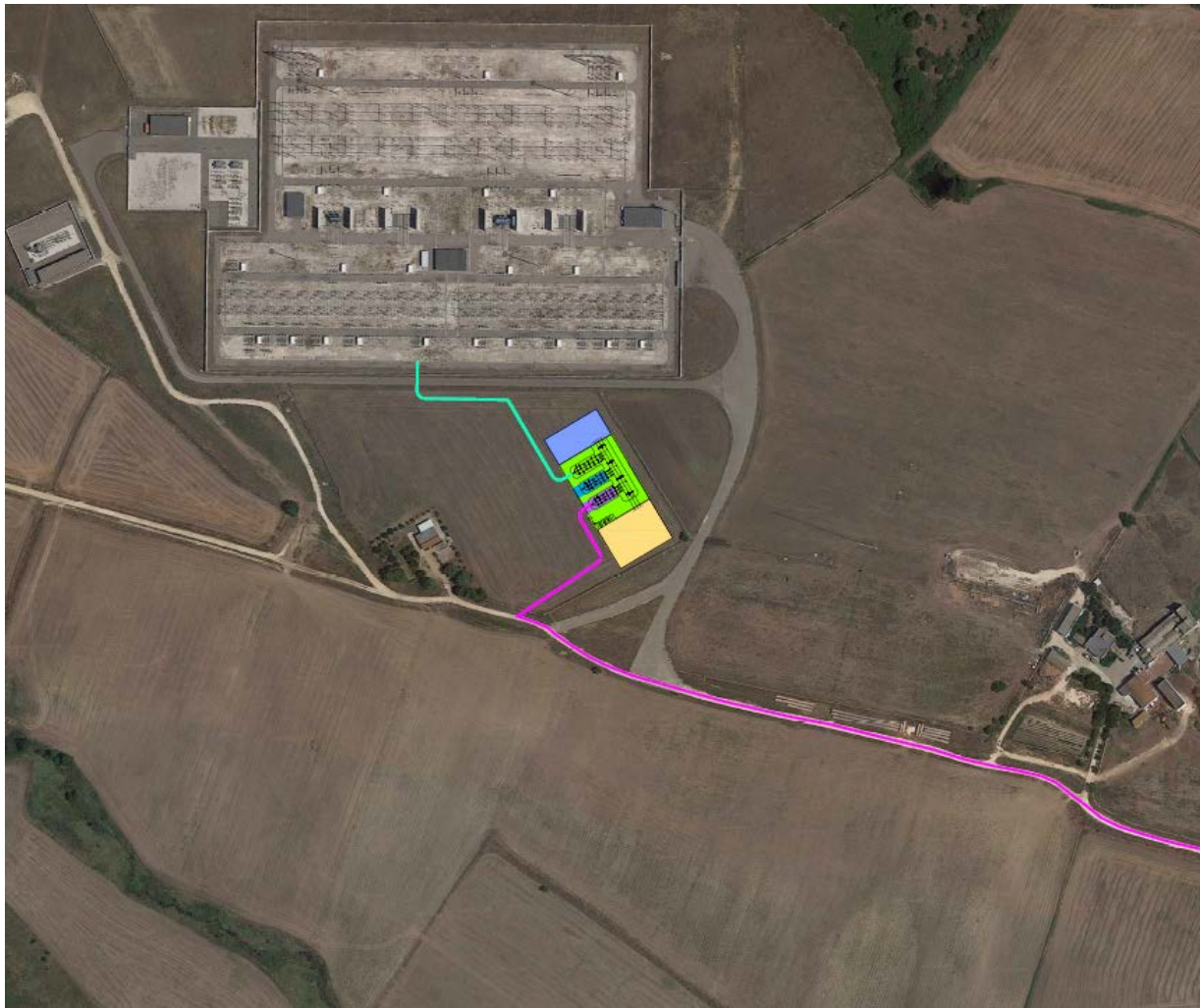
Fig. 8 – Collegamento in cavo AT tra SSEU e SE RTN di Castellaneta
