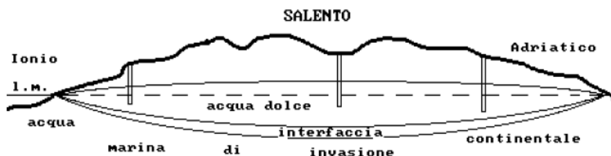
Fig. 5 - Sezione idrologica della Penisola Salentina
