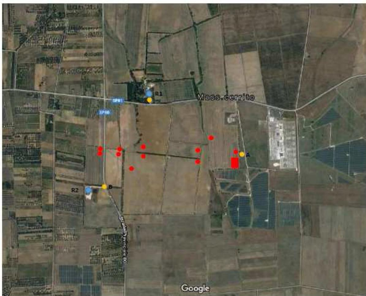
Indicazione dei ricettori (pallini azzurri), delle cabine inverter / trasformazione BT/MT (pallini rossi), dei punti di misurazione di Leq(A) (pallini gialli), il rettangolo rosso indica la Stazione MT/AT
