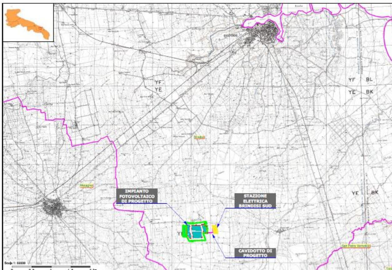
L'impianto fotovoltaico "VERDE SOLARE" sarà allacciato alla Rete di Trasmissione Nazionale (RTN) in antenna con la sezione a 150 Kv del futuro ampliamento ( a carico di TERNA) della stazione elettrica di trasformazione (SE) della RTN 380/150 kV di "Brindisi Sud" (**STMG Codice Rintracciabilità 201900587**)
