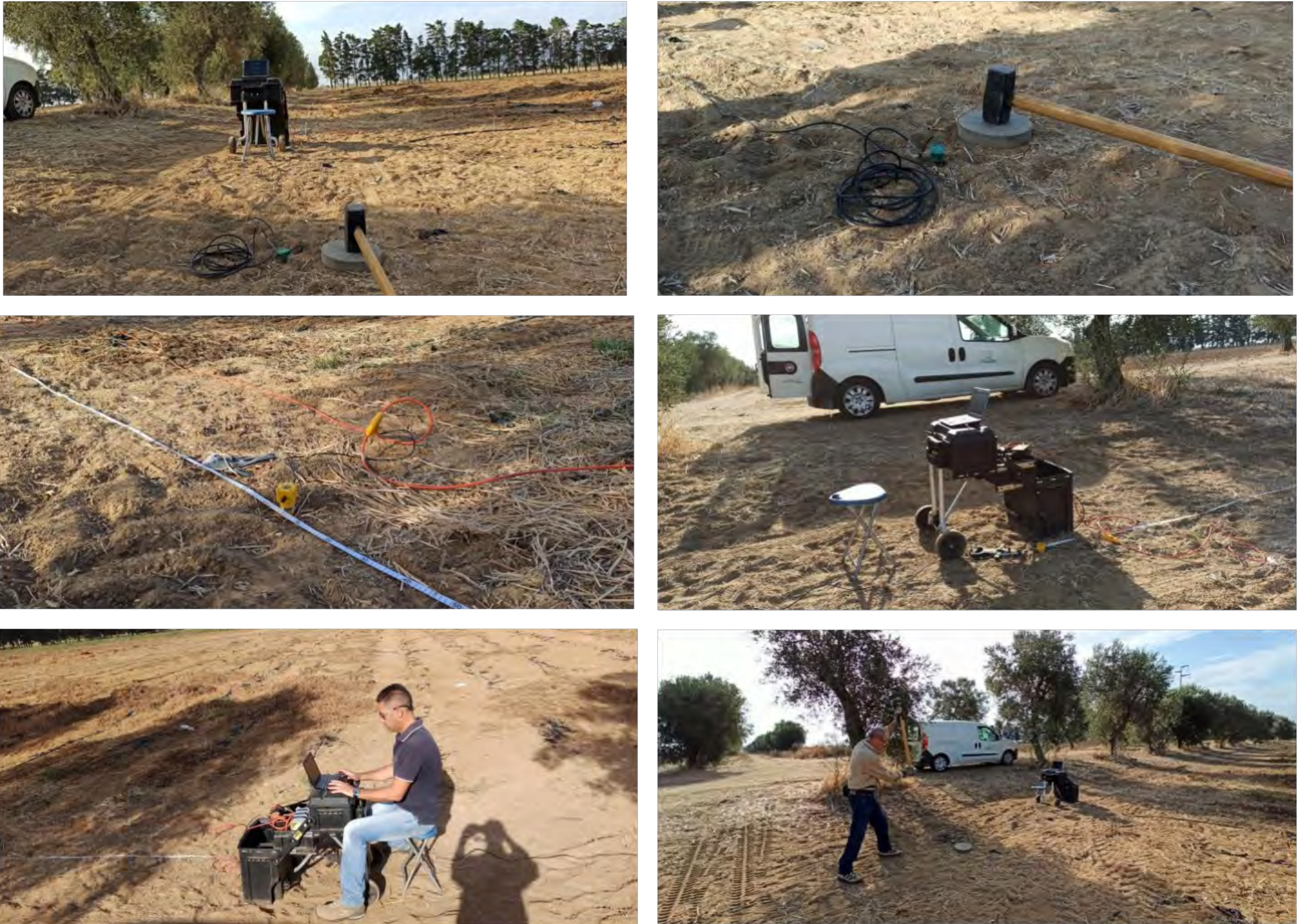
Fig. 9.4: Documentazione fotografica Indagini Sismiche Re.Mi.-MASW
