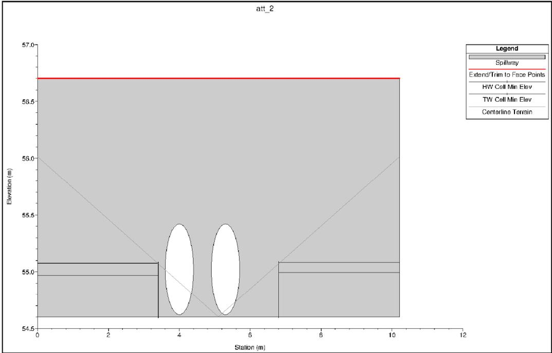
Fig. 8b: Attraversamento "att2" modellato col comando Culvert di Hec-Ras.
