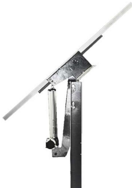
Da un punto di vista strutturale il tracker è realizzato in acciaio da costruzione in conformità all'Eurocodici, con maggior parte dei componenti zincati a caldo. I tracker possono resistere fino a velocità del vento di 55 km/h, ed avviano la procedura di sicurezza (ruotando fin all'angolo di sicurezza) quando le raffiche di vento hanno velocità superiore a 50 km/h.
