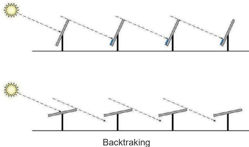
Pertanto, l'intero impianto fotovoltaico con i tracker occupa meno terreno di quelli che fissi. L'assenza di movimento di inclinazione, (cioè il tracciamento "stagionale") ha scarso effetto sull'energia prodotta, cioè non introduce una maggiore produzione rispetto a quanto faccia il tracker monoassiale rispetto ad una struttura fissa, di contro comporta un aumento di costi e complessità del sistema.
