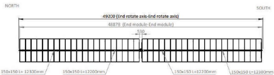
Sono costituite da un montante verticale in acciaio zincato da una testata di supporto alla fondazione su cui vengono installati gli attuatori lineari e gli arcaretti in alluminio orizzontali su cui vengono posizionati i moduli.
