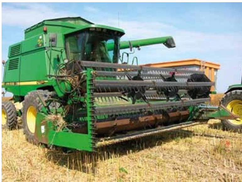
Figura 7: Particolare della barra falciante verticale della mietitrebbia John Deere CTS
