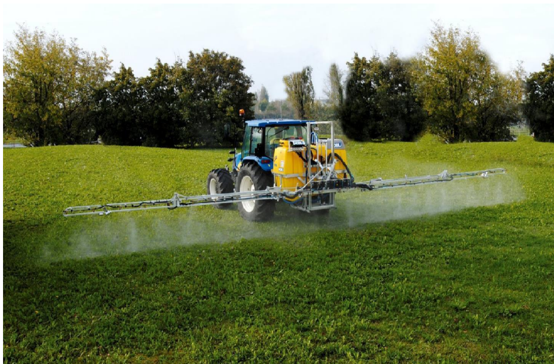
Figura 10: Barra irroratrice con ugelli antideriva
