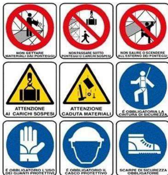
Cartellonistica minima di cantiere
