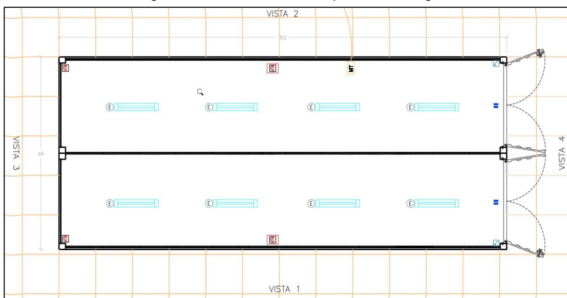
Figura 4.2 – Posizionamento plafoniere Cabina Uffici
