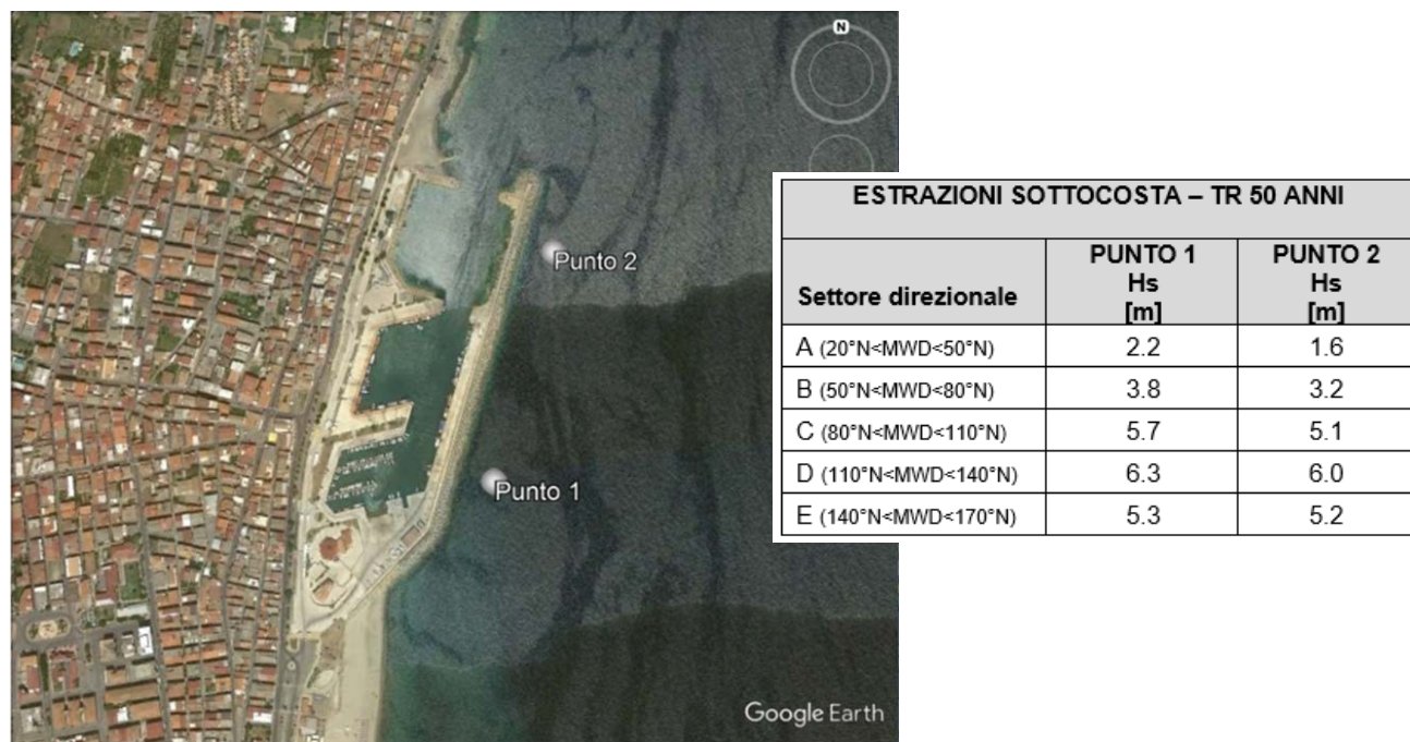
Figura 8.4 Suddivisione della rosa del clima ondoso del punto MWM in settori direzionali di 30°, propedeutica all'analisi statistica degli eventi estremi per assegnato tempo di ritorno e tabella altezze d'onda nel punto MWN per tempo di ritorno pari a 50 anni
