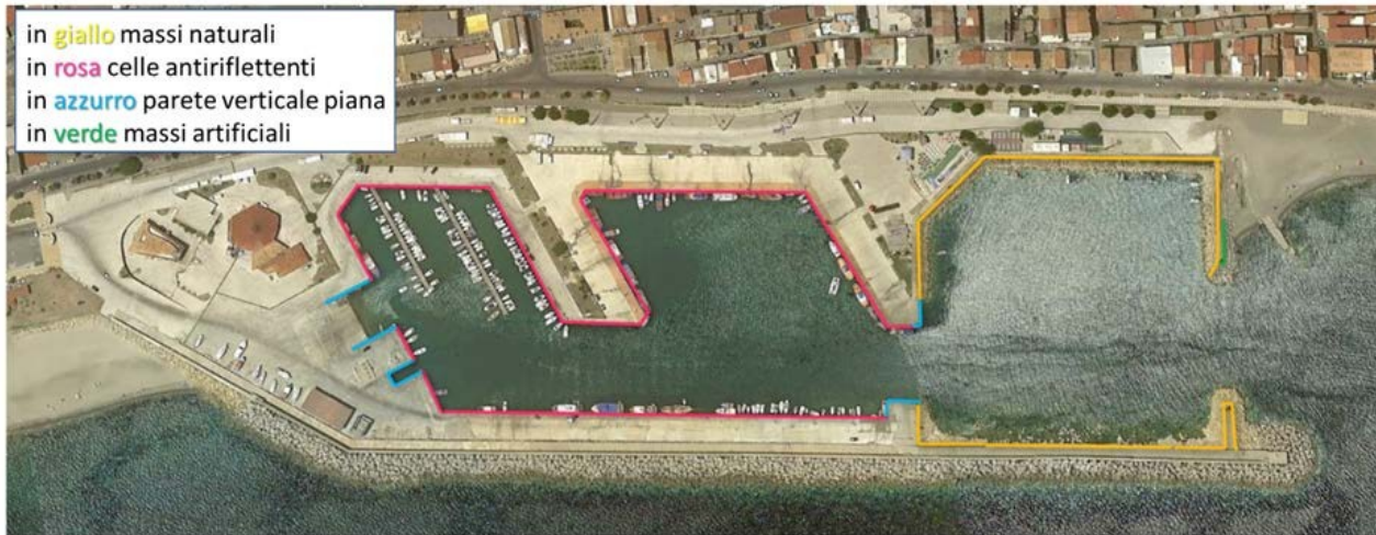
Figura 8.6 Illustrazione delle caratteristiche strutturali del bacino portuale
