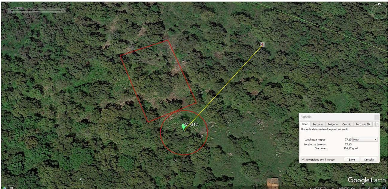
**Figura 9.** Sono indicati: in croce rossa la precedente posizione e in verde il punto di layout spostato, del previsto aerogeneratore WTG12. La distanza di spostamento è di circa 79 m verso S-W. Sono indicati anche i limiti della fondazione e della piazzola.
