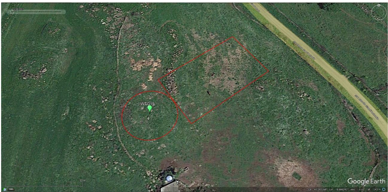
**Figura 11.** In verde il punto di layout spostato del previsto aerogeneratore WTG19. La distanza di spostamento dalla precedente posizione è di circa 994 m verso N-E. Sono indicati anche i limiti della fondazione e della piazzola. Proprio per la realizzazione della piazzola sarà necessario l'allontanamento di un cumulo di pietre, che verrà mitigato (nei confronti dei rettili e di altra piccola fauna terricola) con la realizzazione di appositi rifugi.
