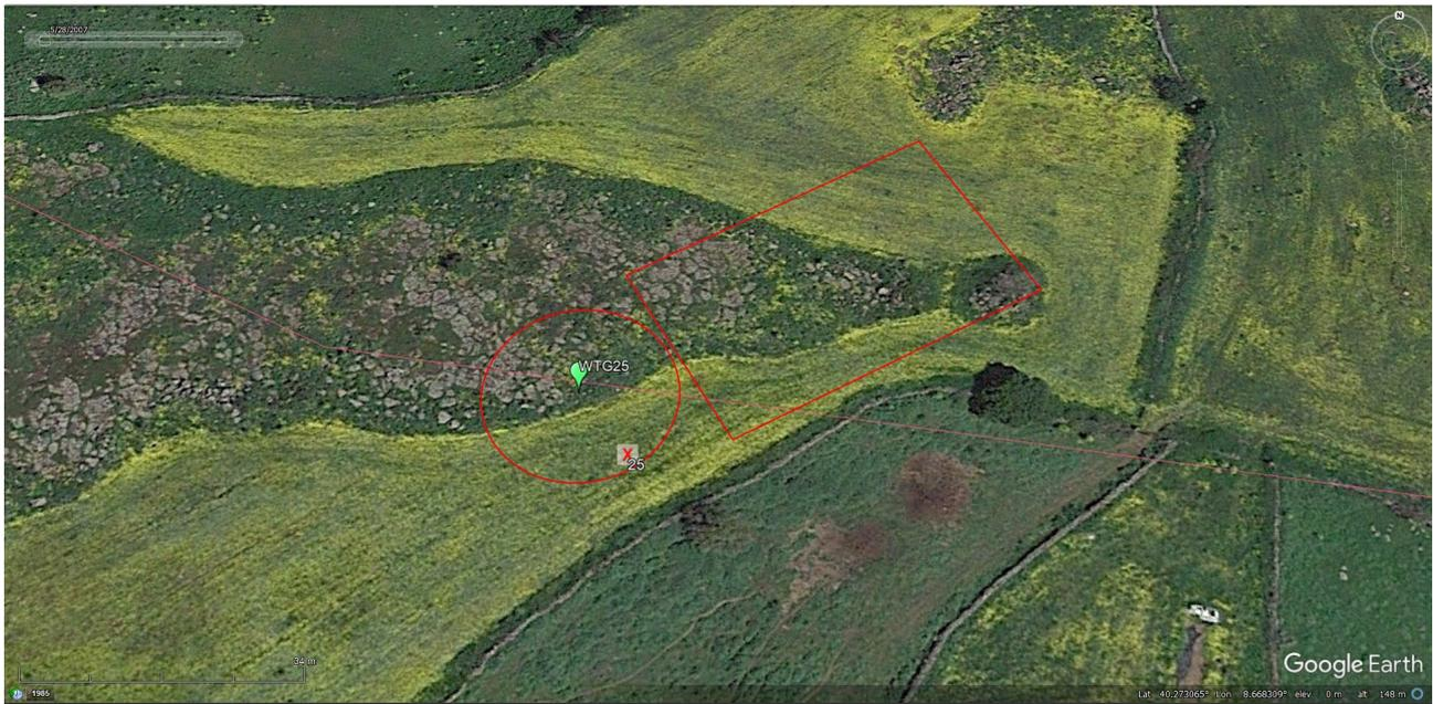
**Figura 17.** Sono indicati: in croce rossa la precedente posizione e in verde il punto di layout spostato, del previsto aerogeneratore WTG25. La distanza di spostamento è di circa 12 m verso N-W. Sono indicati anche i limiti della fondazione e della piazzola.
