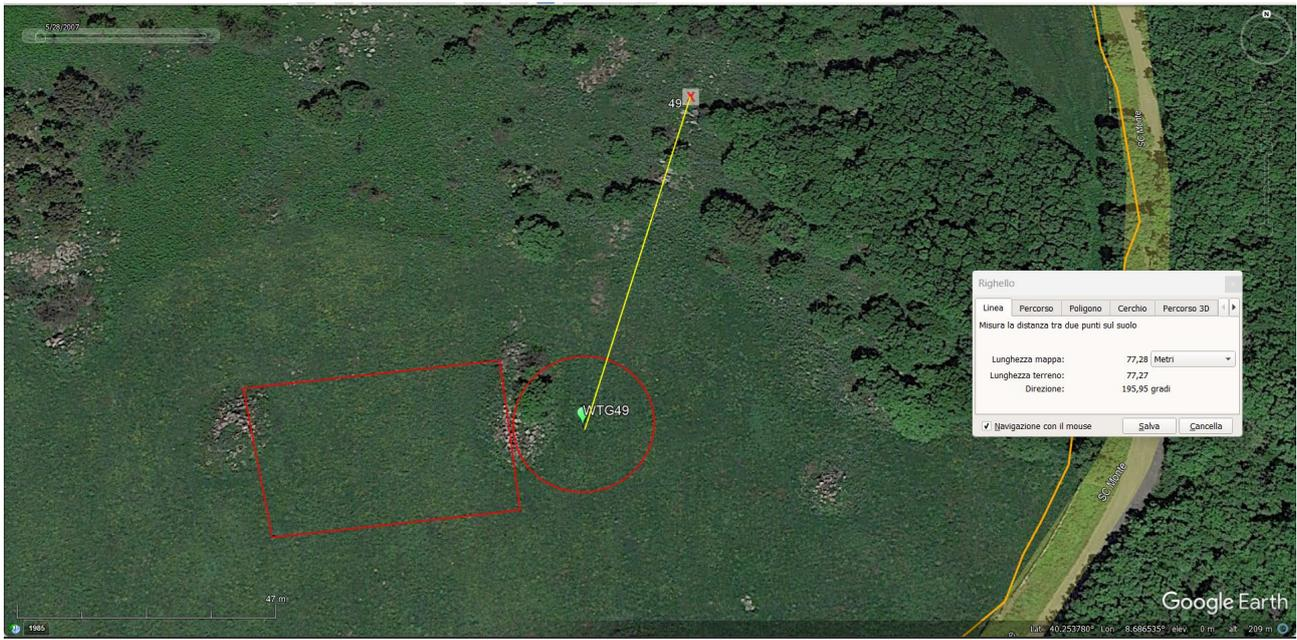
**Figura 29.** Sono indicati: in croce rossa la precedente posizione e in verde il punto di layout spostato, del previsto aerogeneratore WTG49. La distanza di spostamento è di circa 78 m verso S-W. Sono indicati anche i limiti della fondazione e della piazzola.
