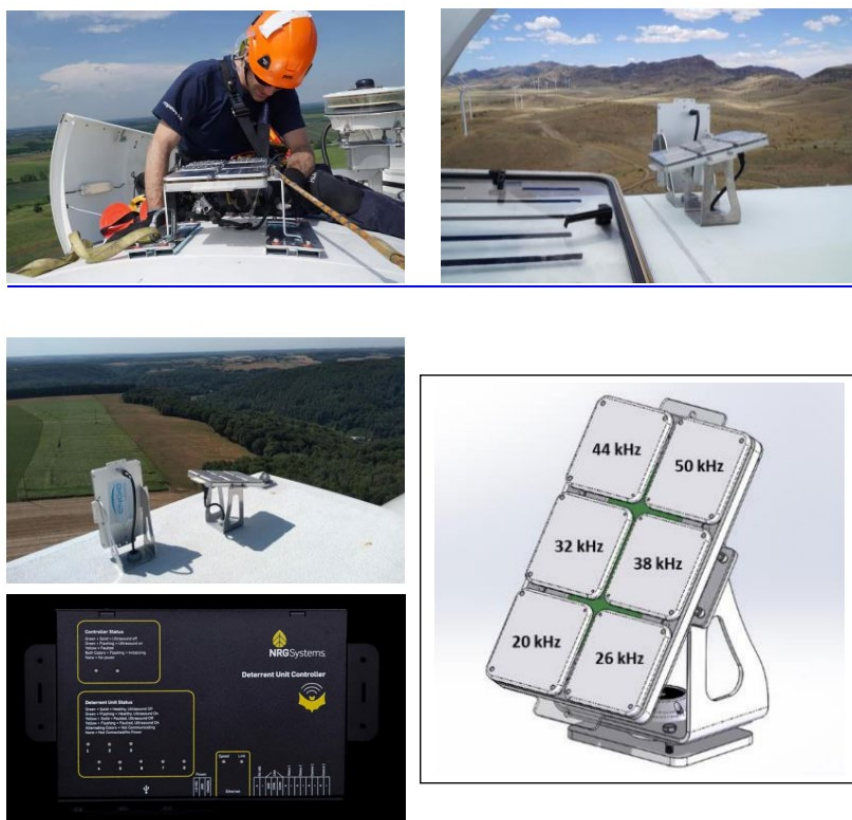
Figura 13. Sopra, il montaggio degli emettitori acustici ultrasonici della NRG, sui lati e sulla parte superiore di una nacella presso un impianto eolico. I risultati positivi si hanno con una perfetta programmazione (conoscenza stretta della chiroterrofauna presente) ed al "dosaggio" preciso delle frequenze ultrasoniche tra i diversi "emettitori" grazie ai dati derivanti dai pregressi monitoraggi circa le specie più attive o più a rischio di impatto.
