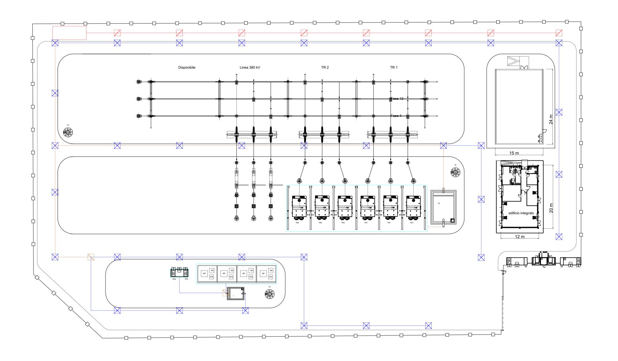
trincea drenante Tubazione Ø500 Tubazione Ø630 mm Pozzetto di raccordo Pozzetto 1mx1m con caditoia pozzo disperdente Vasca raccolta olio trasformatori Tramoggia raccolta olio Sistema trattamento acque
