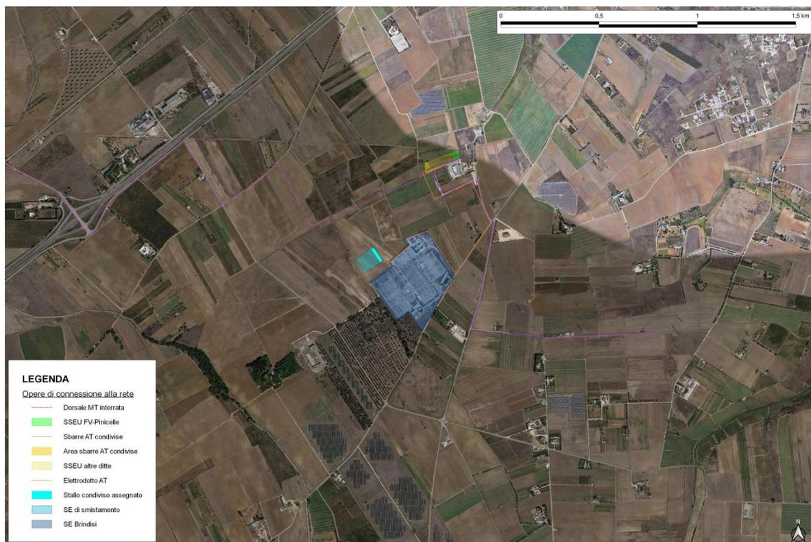
Figura 1-4 - Ortofoto del collegamento allo stallo condiviso assegnato, da realizzare in una futura stazione di smistamento 150 kV da costruire nelle immediate vicinanze della Stazione di Trasformazione 380/150 kV "Brindisi"
