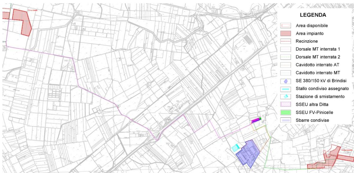
Figura 1-2- Schema di convogliamento dell'energia dalle cabine di parallelo ubicate rispettivamente nei sottoimpianti FV-La Gonnella e FV-Lo Spada alla Sottostazione Elettrica Utente 150/30 kV (SSEU FV-Pinicelle) e da questa allo stallo condiviso assegnato, da realizzare in una futura stazione di smistamento 150 kV da costruire nelle immediate vicinanze della Stazione di Trasformazione 380/150 kV "Brindisi"
