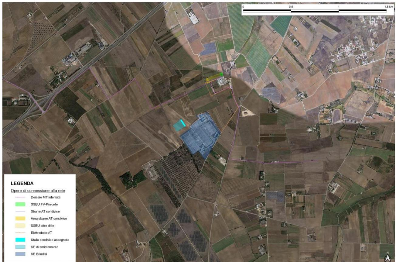
Figura 1-3 - Ortofoto del collegamento allo stallo condiviso assegnato, da realizzare in una futura stazione di smistamento 150 kV da costruire nelle immediate vicinanze della Stazione di Trasformazione 380/150 kV "Brindisi"
