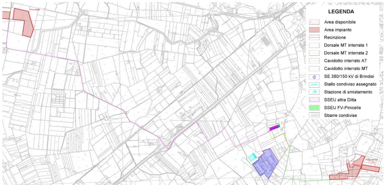
Figura 5 7 - Schema di convogliamento dell'energia dalle cabine di parallelo ubicate rispettivamente nei sotto-impianti FV-La Gonnella e FV-Lo Spada alla Sottostazione Elettrica Utente 150/30 kV (SSEU FV-Pinicelle) e da questa allo stallo condiviso assegnato, da realizzare in una futura stazione di smistamento 150 kV da costruire nelle immediate vicinanze della Stazione di Trasformazione 380/150 kV "Brindisi".
