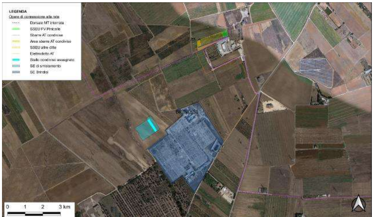
Figura 2-3 - Ortofoto del collegamento allo stallo condiviso assegnato, da realizzare in una futura stazione di smistamento 150 kV da costruire nelle immediate vicinanze della Stazione di Trasformazione 380/150 kV "Brindisi".
