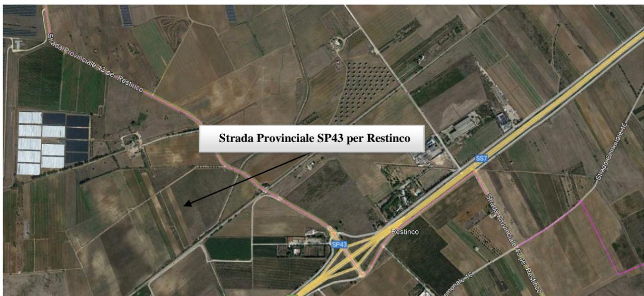
Figura 3-11 - Interferenza della Dorsale interrata in MT con la rete stradale esistente: Strada Provinciale SP43 per Restinco
