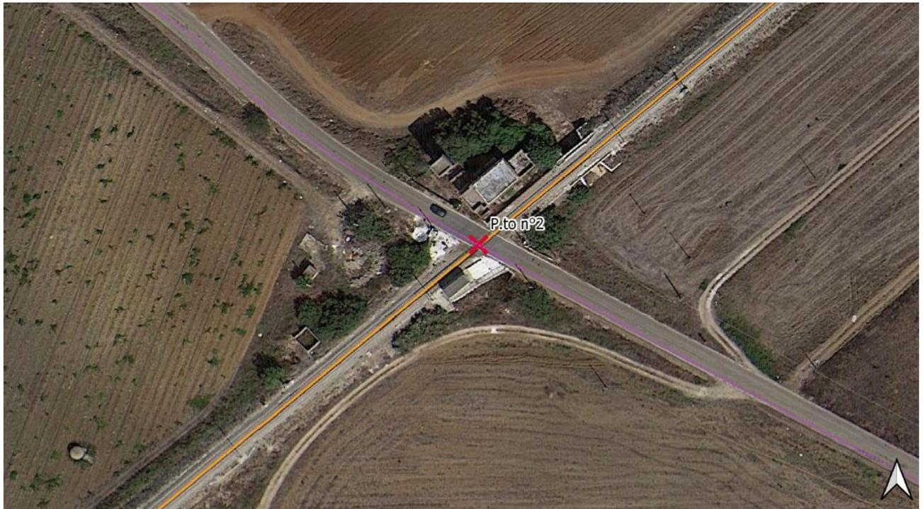
*Figura 3-19 - Dettaglio Punto 2 - Interferenza di attraversamento con TOC della Dorsale interrata in MT di collegamento alla SSEU con la rete ferroviaria esistente*
