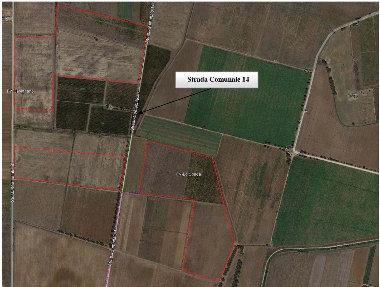
Figura 3-4 - Interferenza dei sotto-impianti agro-fotovoltaici FV-Lo Spada e FV-Casignano con la rete stradale esistente: Strada Comunale 14
