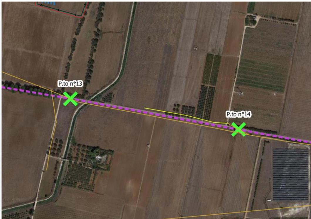
Figura 3-33 - Dettaglio Punto 13 - Interferenza di attraversamento della Dorsale interrata in MT con linea elettrica area MT esistente
