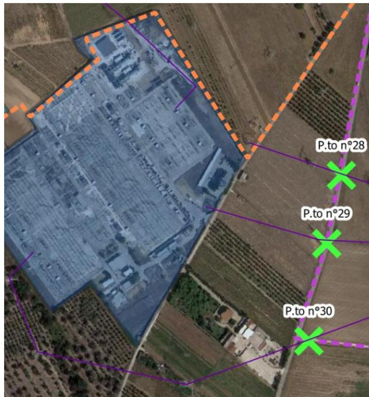
Figura 3-40 - Dettaglio Punto 28 - Interferenza di attraversamento della Dorsale interrata in MT con linea elettrica area AT esistente
