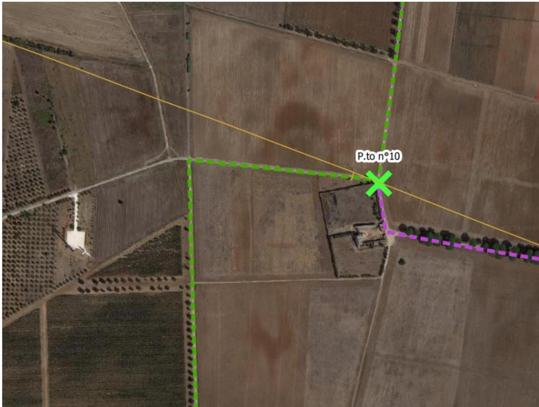
Figura 3-31 - Dettaglio Punto 10 - Interferenza di attraversamento del cavidotto interrato in MT di parallelo e della Dorsale interrata in MT con linea elettrica area MT esistente
