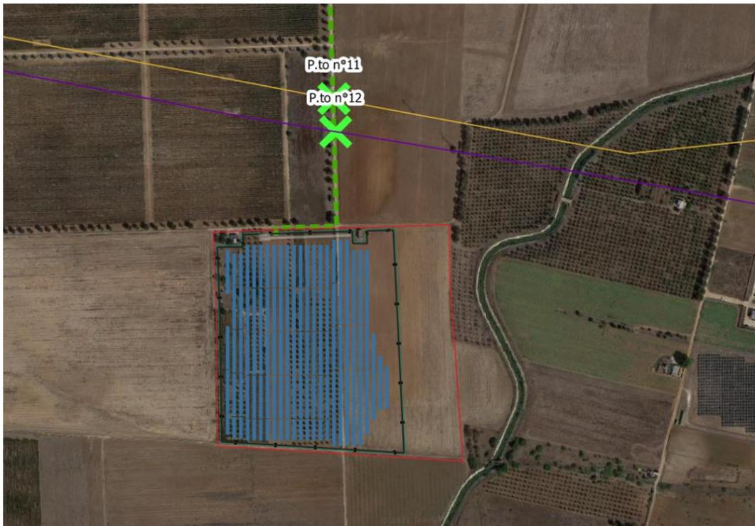
Figura 3-32 - Dettaglio Punto 11 - Interferenza di attraversamento del cavidotto interrato in MT di parallelo con linea elettrica area MT esistente
