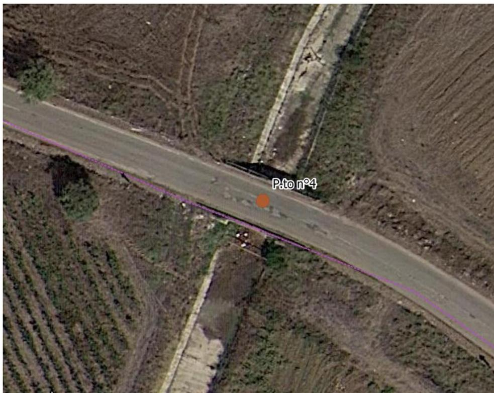
*Figura 3-24 - Dettaglio Punto 4 - Interferenza di fiancheggiamento della Dorsale interrata in MT con ponte esistente*
