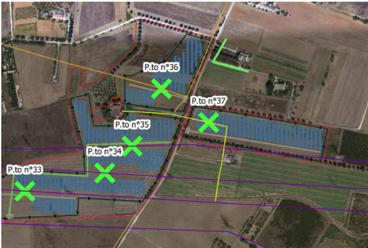
Figura 3-8 - Dettaglio - Interferenza del sotto-impianto agro-fotovoltaico FV-La Gonella con linee elettriche esistenti: P.to 33 - linea elettrica area AT, P.to 34 - linea elettrica area AT, P.to 35 - linea elettrica area AT, P.to 36 - linea elettrica area MT, P.to 37 - linea elettrica area BT per la quale verrà prodotta istanza di richiesta per lo spostamento all'ente gestore
