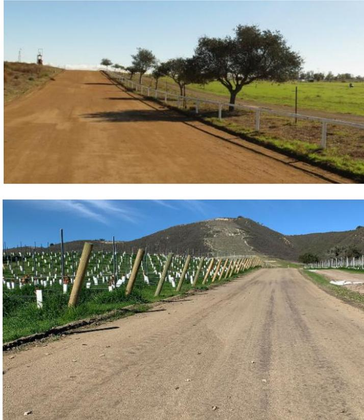
*Figura 2-16 - Esempi di strade in terra stabilizzata*
