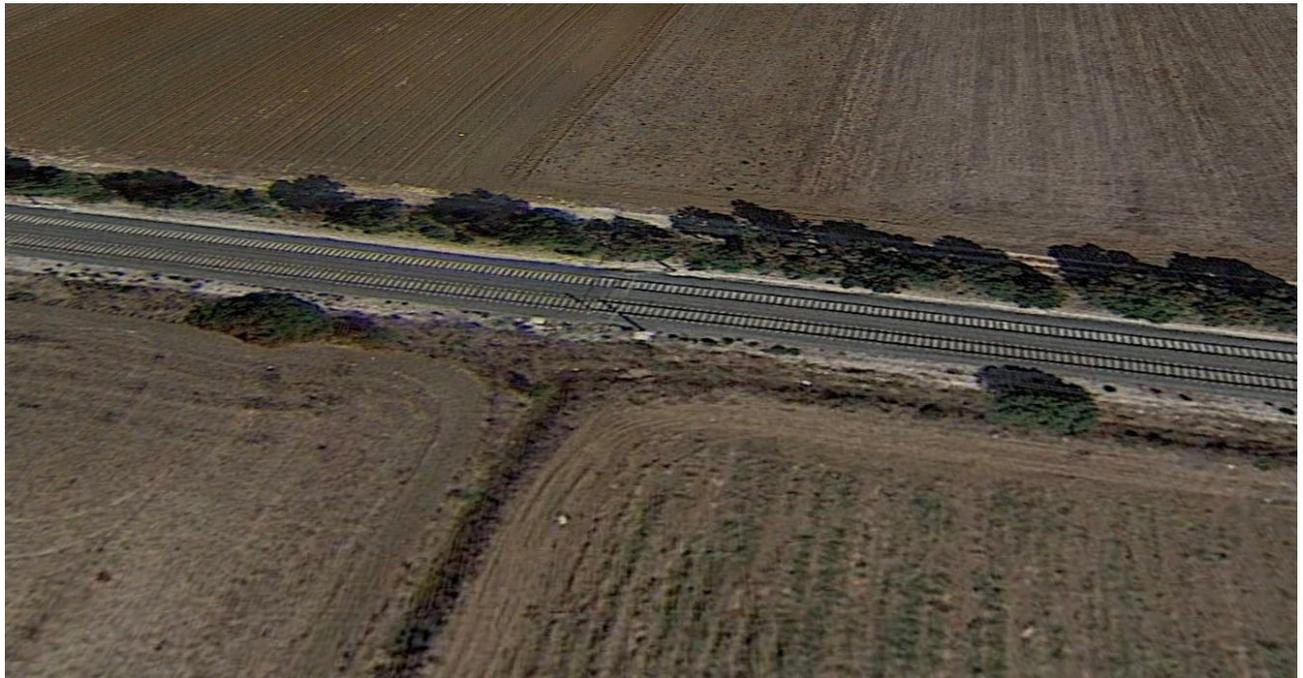
*Figura 3-18 - Vista a volo di uccello del Punto 1 - Interferenza di attraversamento con TOC del cavidotto interrato in MT di parallelo con la rete ferroviaria esistente*
