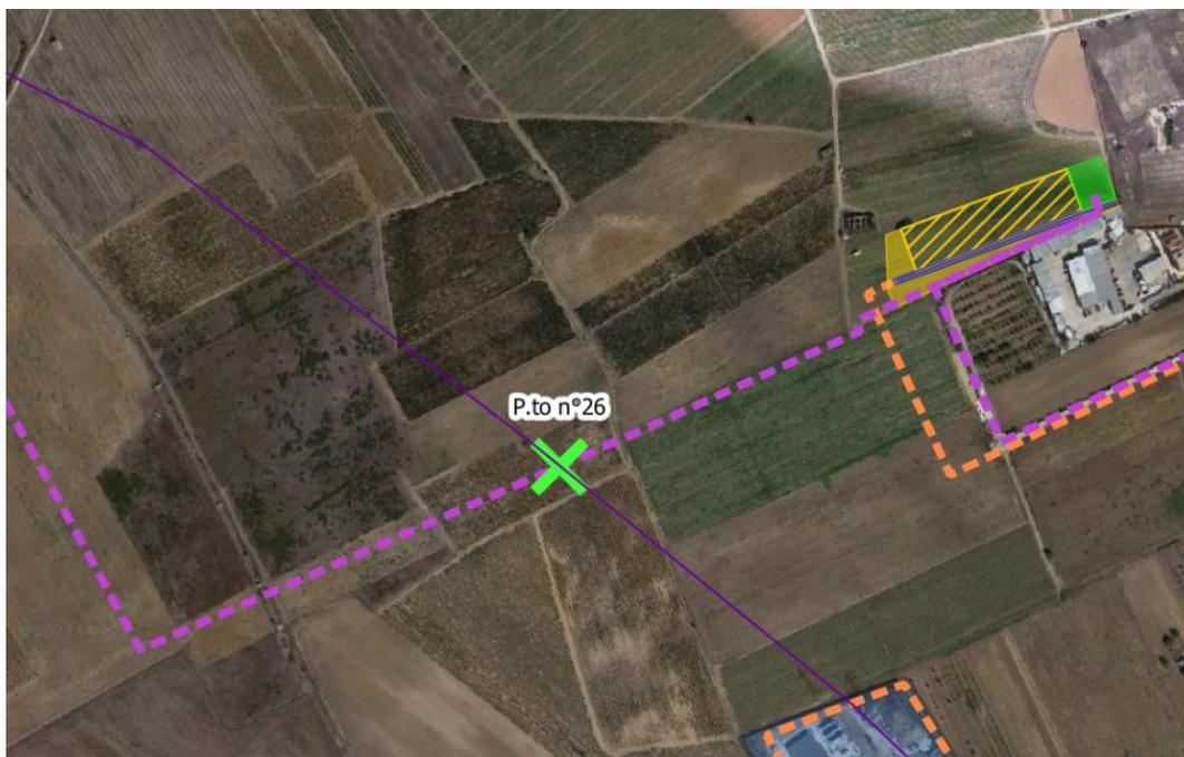
*Figura 3-38 - Dettaglio Punto 26 - Interferenza di attraversamento della Dorsale interrata in MT con linea elettrica area AT esistente*
