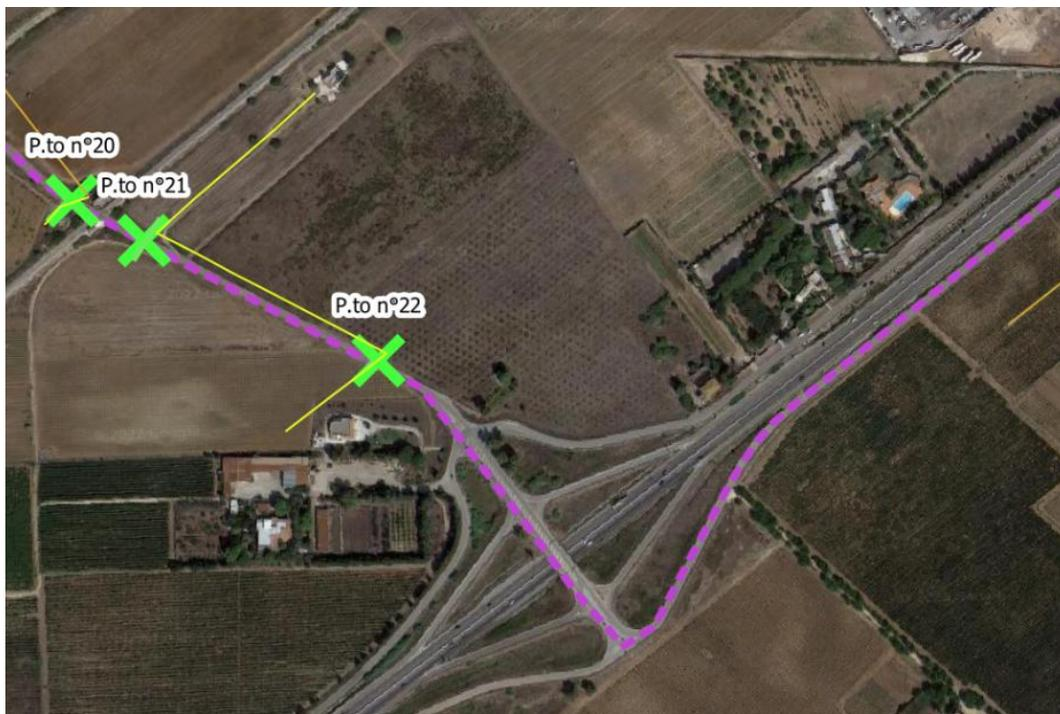
Figura 3-36 - Dettaglio Punto 20 - Interferenza di attraversamento della Dorsale interrata in MT con linea elettrica area BT esistente
