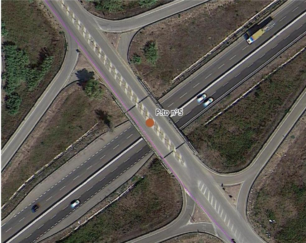
Figura 3-26 - Dettaglio Punto 5 - Interferenza di fiancheggiamento della Dorsale interrata in MT con ponte esistente
