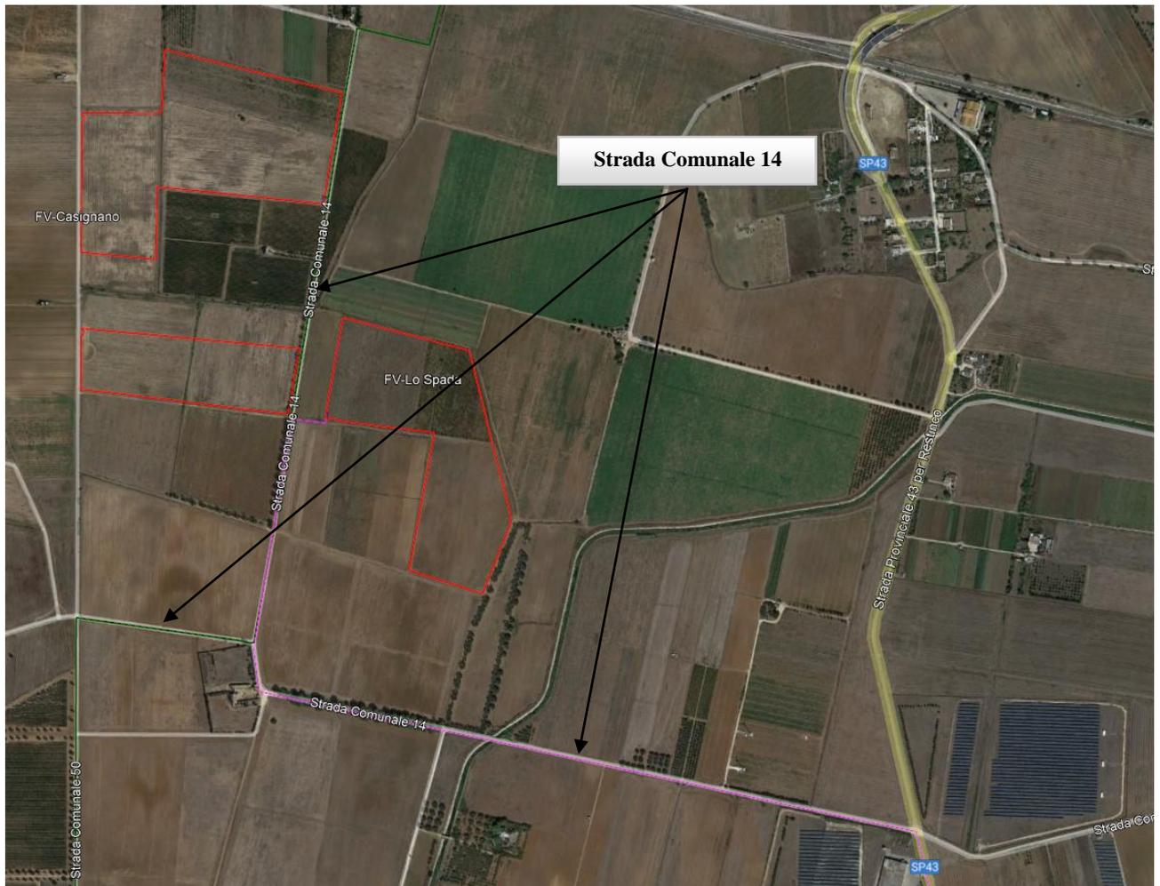
Figura 3-9 - Interferenza del cavidotto interrato in MT di parallelo e della Dorsale interrata in MT con la rete stradale esistente: Strada Comunale 14
