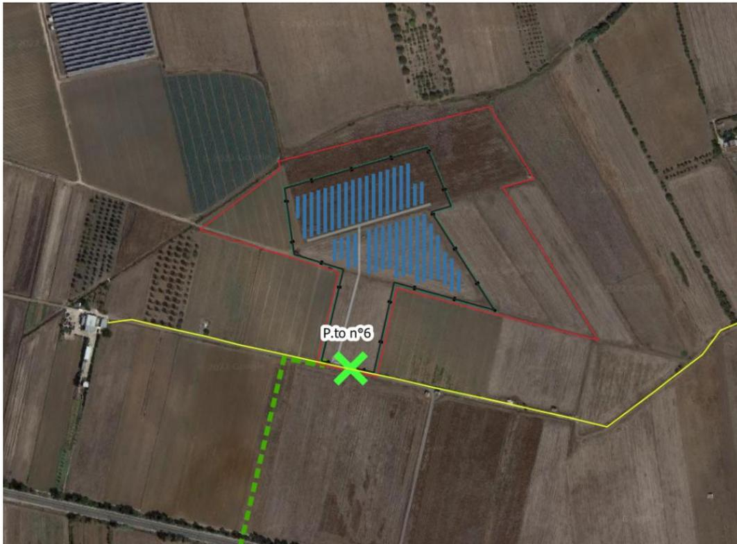
Figura 3-29 - Dettaglio Punto 6 - Interferenza di attraversamento del cavidotto interrato in MT di parallelo con linea elettrica area BT esistente
