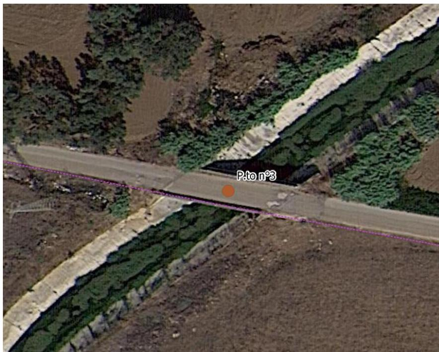
Figura 3-22 - Dettaglio Punto 3 - Interferenza di fiancheggiamento della Dorsale interrata in MT con ponte esistente
