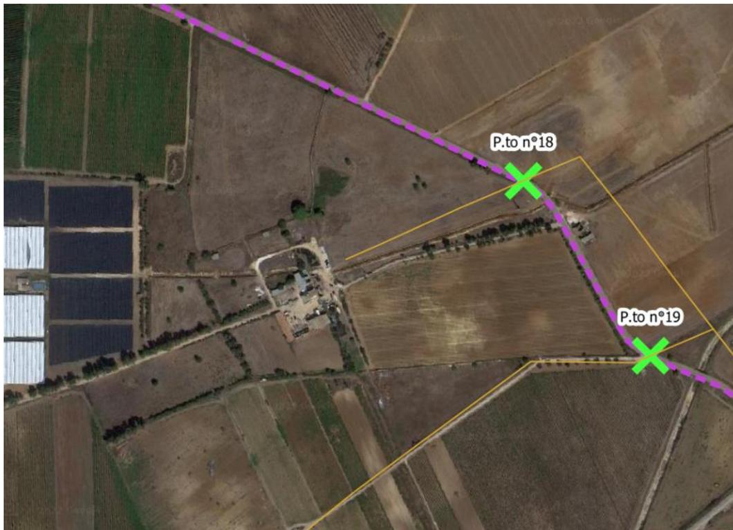
Figura 3-35 - Dettaglio Punto 18 - Interferenza di attraversamento della Dorsale interrata in MT con linea elettrica area MT esistente
