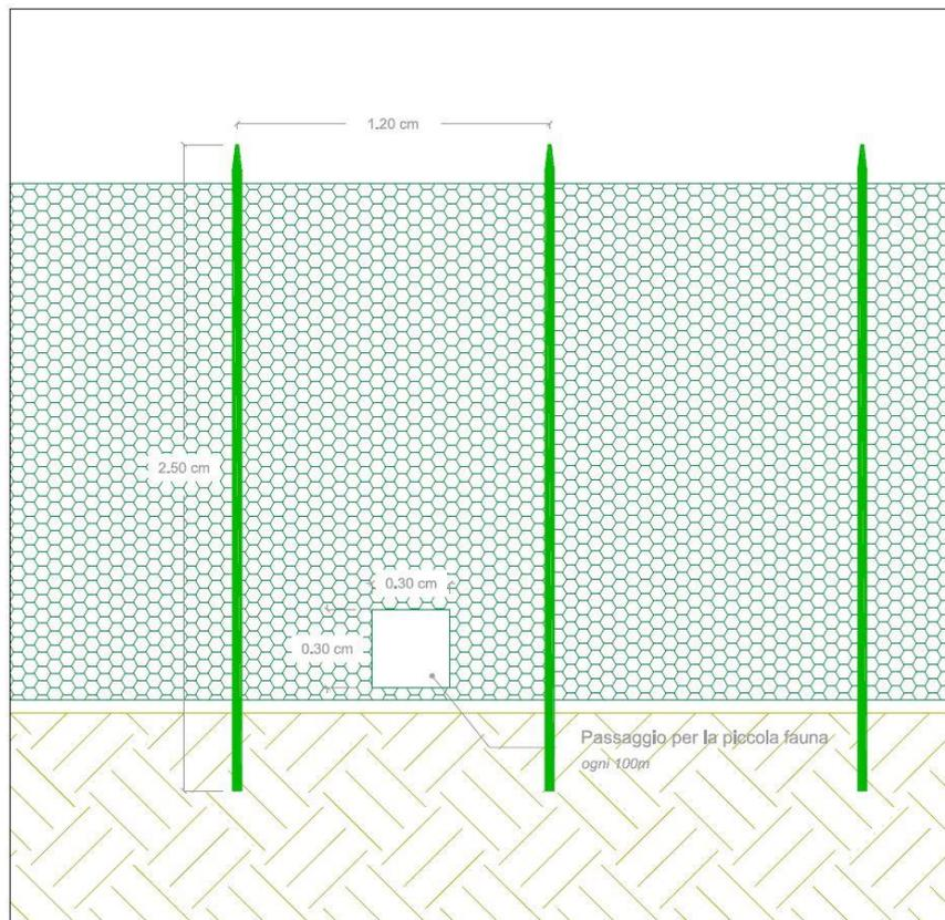
Figura 6-2 - Dettaglio recinzione con apertura per il passaggio della piccola fauna
