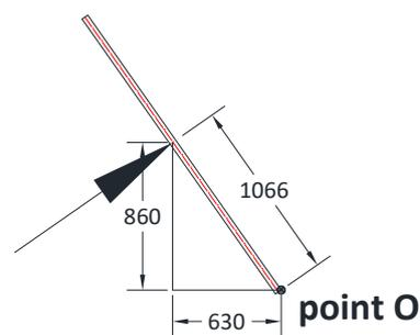
Il pannello utilizzato nel progetto ha una lunghezza pari a  $L=2182\text{ mm}$ , per tale ragione, le coordinate del centro di pressione sono:
