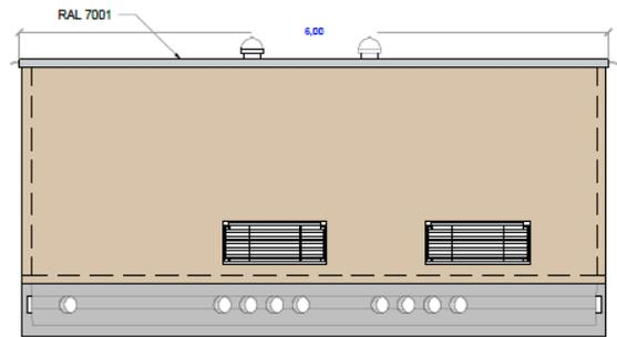
*Figura 3-16 - Prospetto frontale e posteriore Cabina Trafo*
