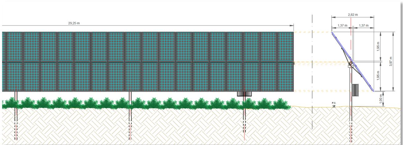
Figura 3-10 - Vista frontale e vista in sezione con rotazione di 55°, (per le opere agricole si rimanda alla relazione specialistica)
