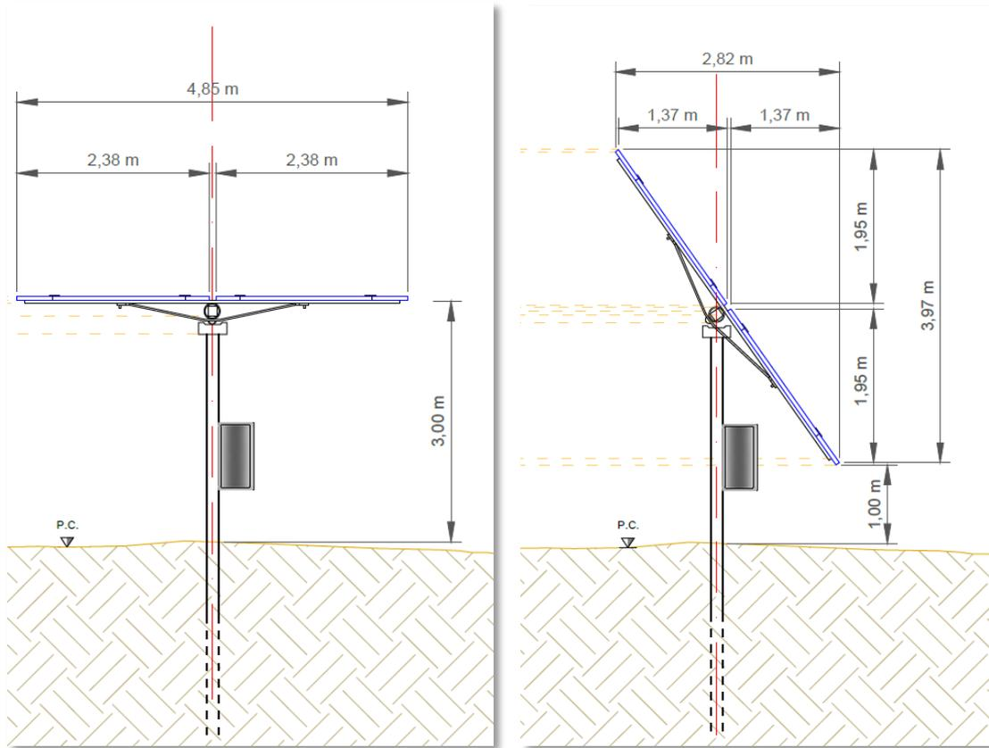
Figura 3-6 - Particolare costruttivo vista in sezione delle strutture di sostegno dei moduli fotovoltaici con rotazione di  $0^\circ$  e  $55^\circ$
