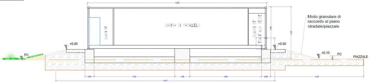
Figura 3-12 - Sezione Cabina di Parallelo
